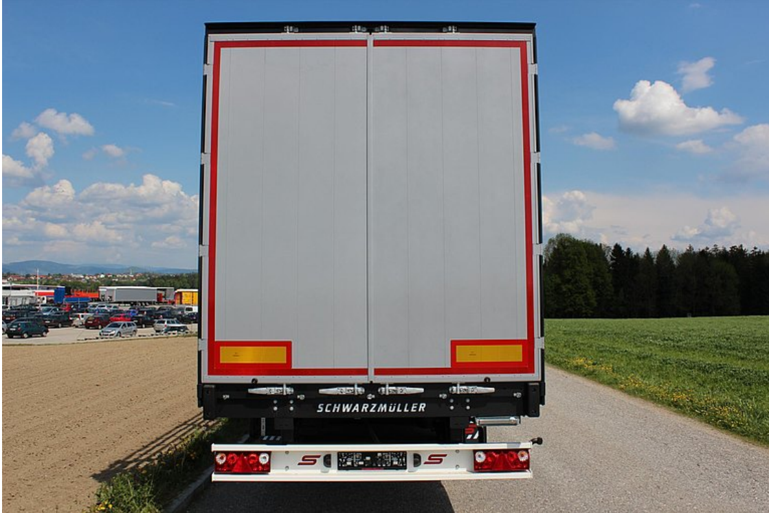
OPCIONÁLIS: portálkeret teliajtóval - hátul csavarkötéssel rögzített portál, kétszárnyú teliajtó alumínium profilokból
