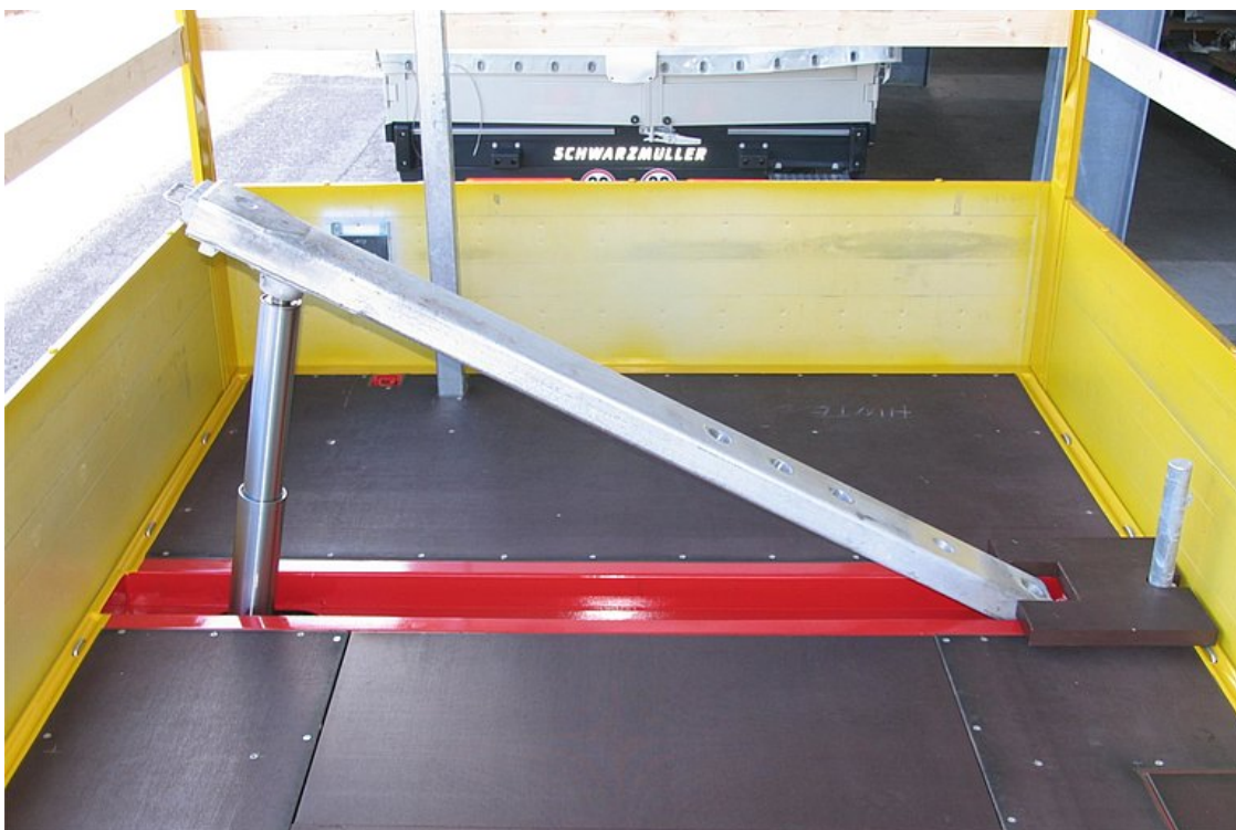
Süllyesztve beépített, kihúzható támaszték, 4 hidraulikus munkahengerrel
