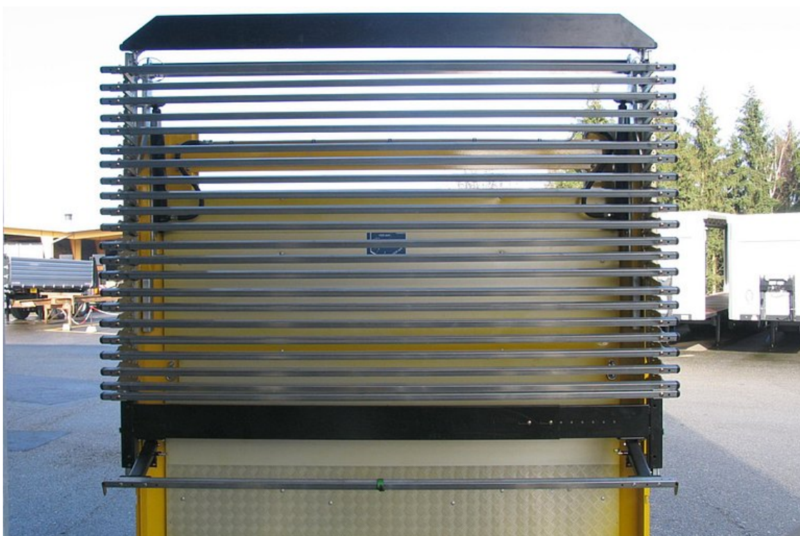
Mellfal belsejére hidraulikusan lehajtható rolós tetőszerkezet - nyitott áruszállításhoz
