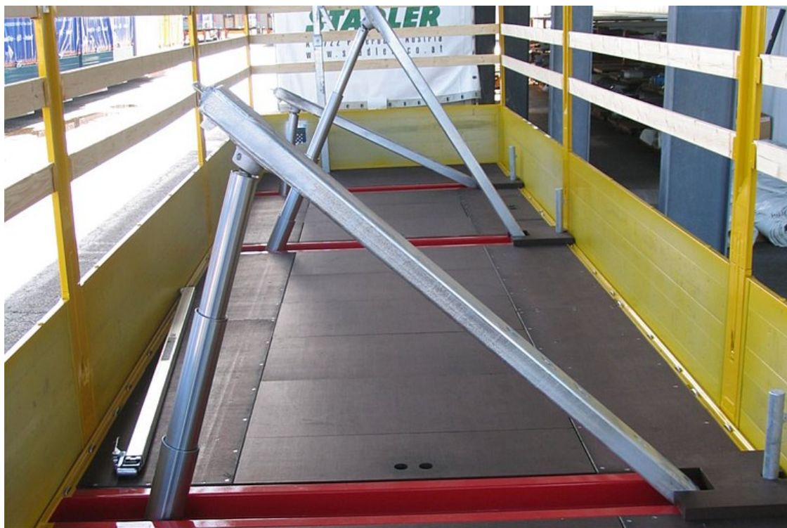
Hidraulikus, ferde raktér kialakítás - nagy felületű, 3.300 mm szélességű acéllemez szállítására
