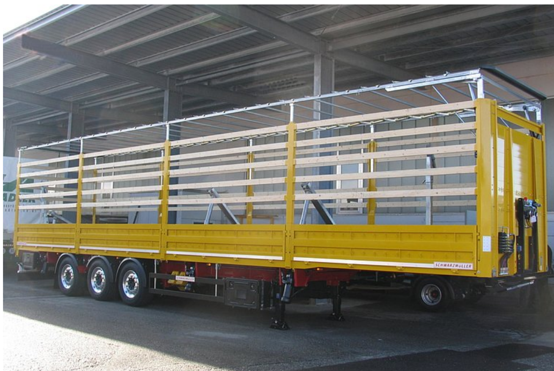
3-tengelyes, könnyűszerkezetű, síkplatós félpótkocsi - tekerccs szállító - ferde raktér kialakítás
