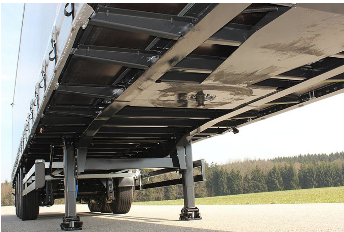
Csavarodásálló hegesztett létra-alváz acélkonstrukció
