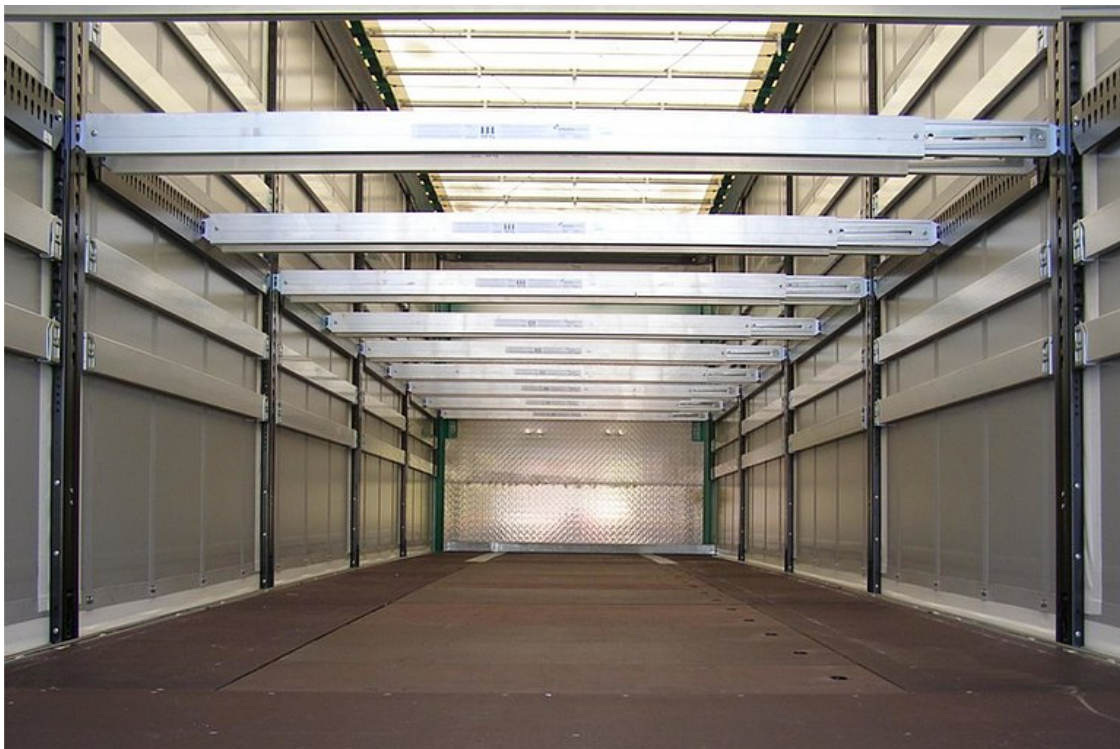
CTD III szerinti dupla rakterű kivitel, 33 Euro-raklap szállítására a 2. raktérben
