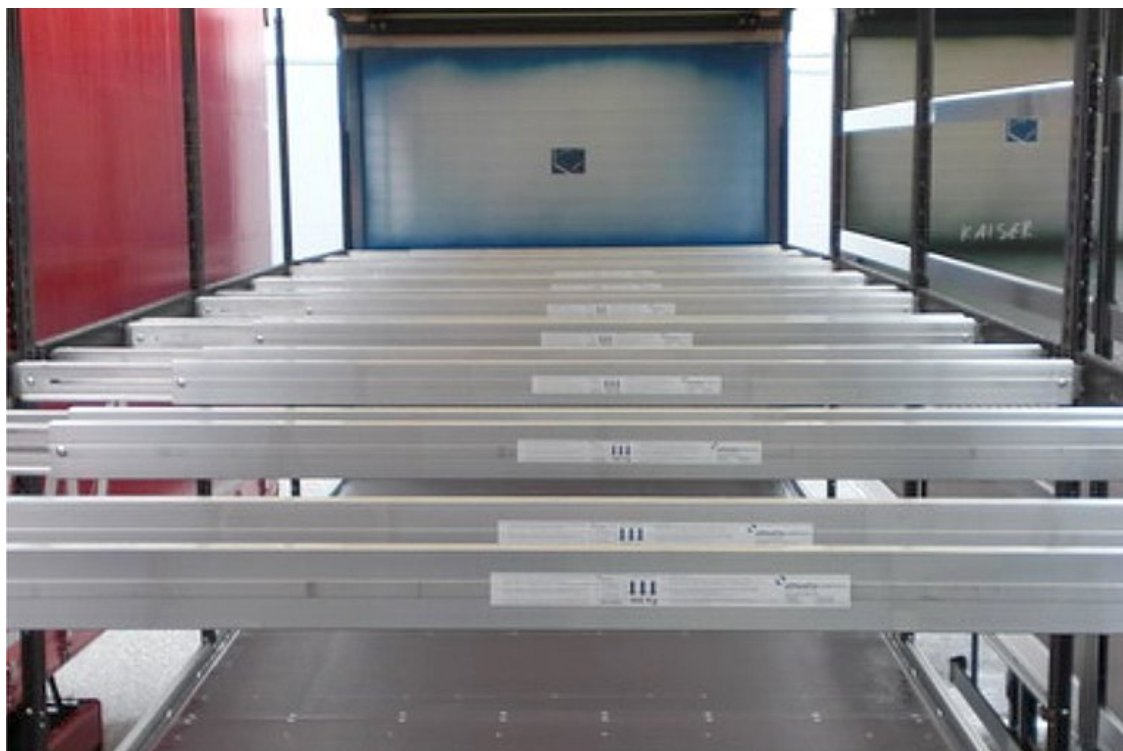
6 rakodási mező, összesen 22 alumínium gerendával, raklaponként 400 kg teherbírással
