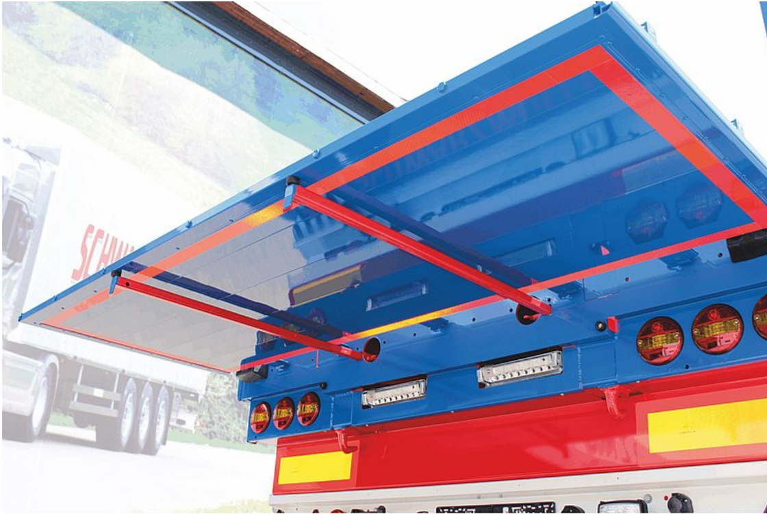
OPCIONÁLIS: 2 kihúzható támasz a hátfal ideiglenes elhelyezésére (nem terhelhető)
