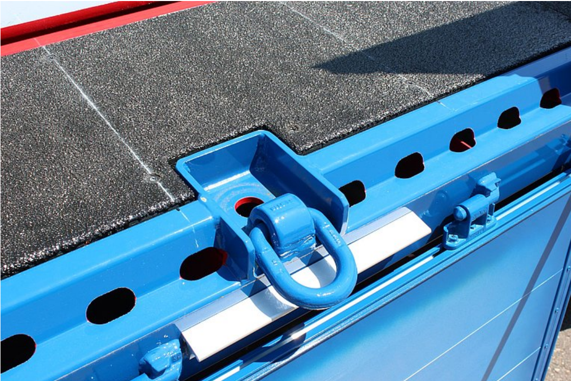
OPCIONÁLIS: keretszegélybe süllyesztett, felhajtható 5 to lekötőgyűrű, kifelé is billenthető
