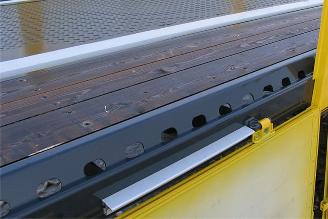
Furatos keretszegély ca. 100 mm lyuktávolsággal, 50/30 mm oválfuratokkal, rögzítési pontonként 2 t
