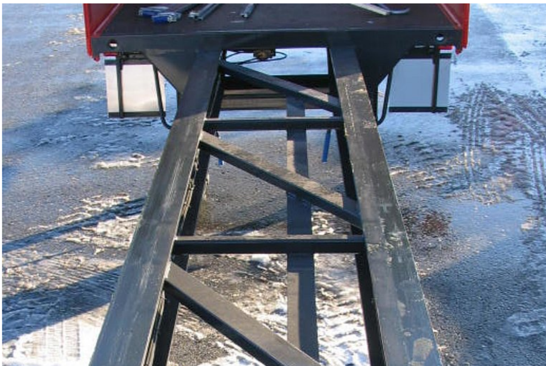
Könnyűszerkezetű, 6 m hosszban kihúzható alváz, 22 m hosszú termékek szállítására
