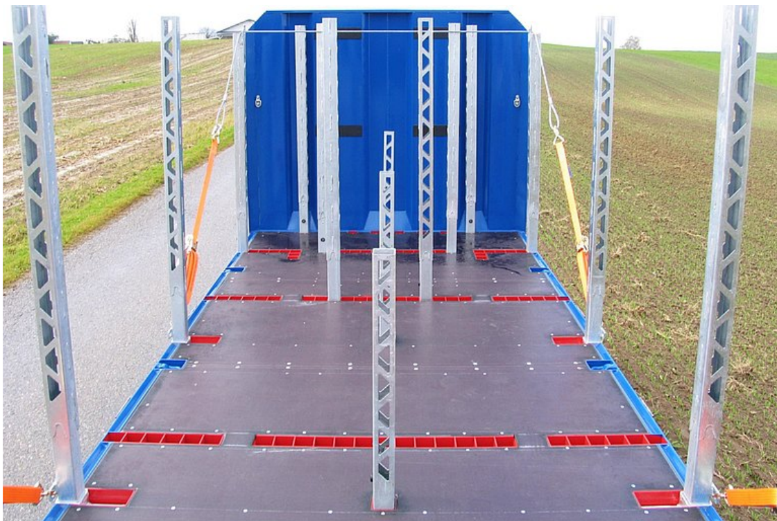
Rakoncazsebek a 6.000 mm hosszú, felhalmozott acélháló rakományrögzítéséhez
