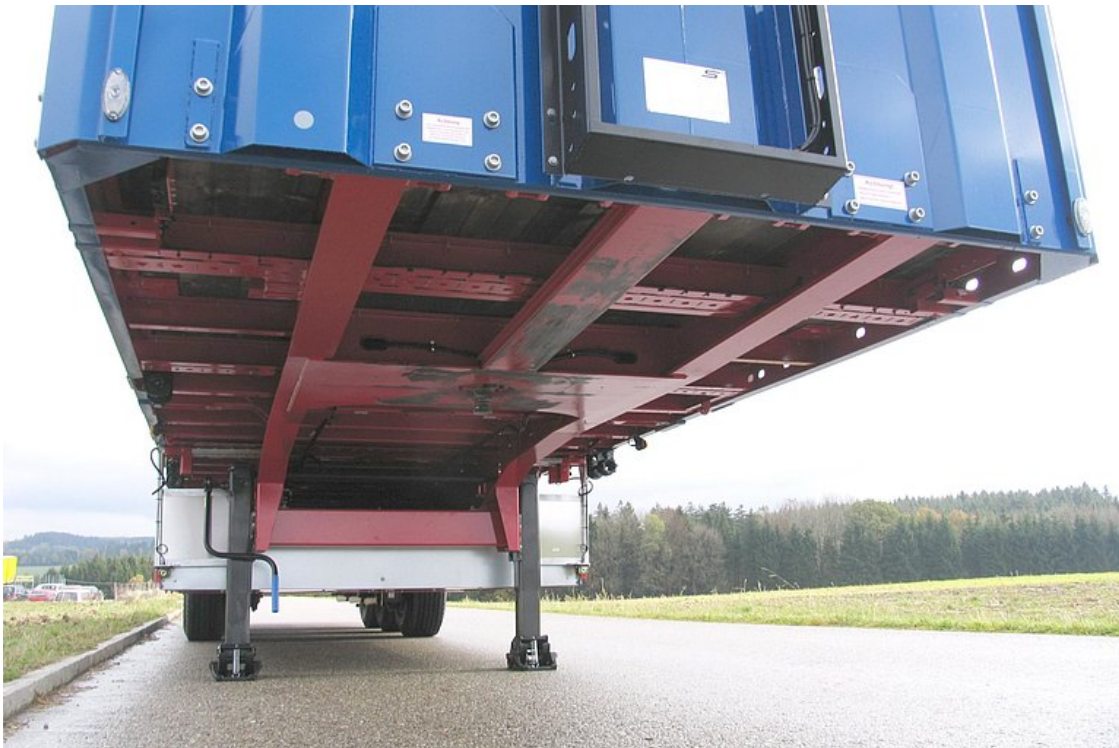
Hegesztett szerkezetű, csavarodástűrő létraváz
