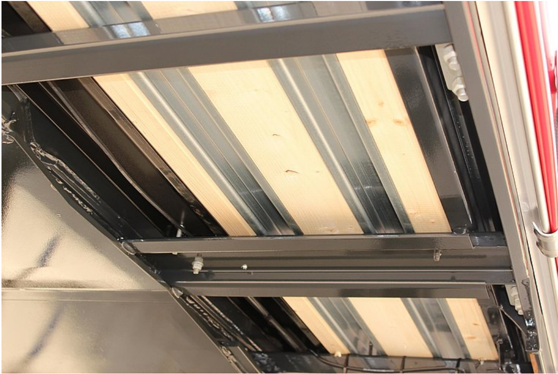
Dupla padló, mely egyrészt acél omegasinekkal erősített fenyőfa padló, valamint egy érdesített koptató lemez (7 t targoncatengely-terhelés)
