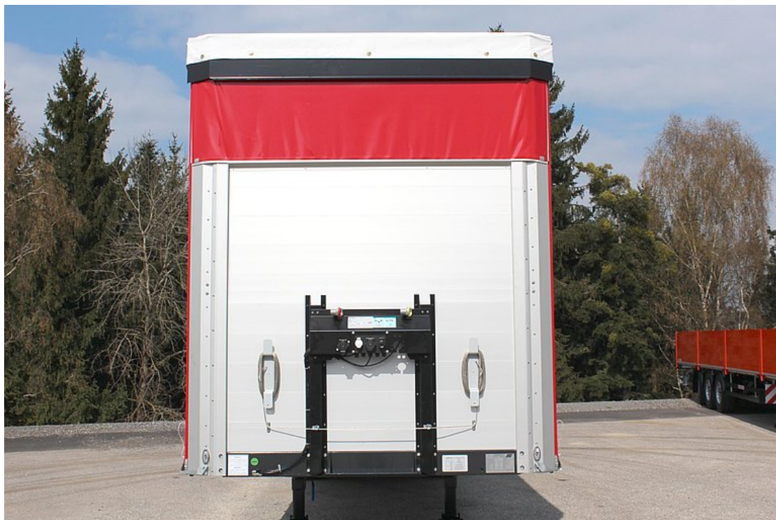
Erősített, üreges alumínium profil mellfal, aljzattartóval
