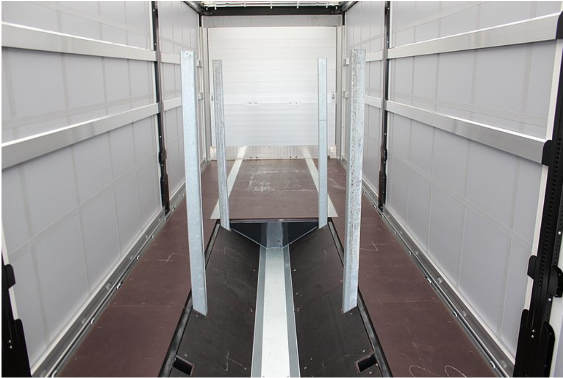
Kábelvályú hasznos hossza ca. 7.400 mm, 5 pár rakoncazseb, 2.100 mm átmérőjű kábeldobhoz
