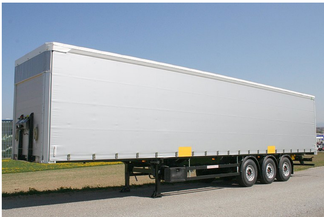
Felépítmény-elemek magas minőségű, korróziómentes alumíniumból, EN 12642 XL szerint vizsgálva
