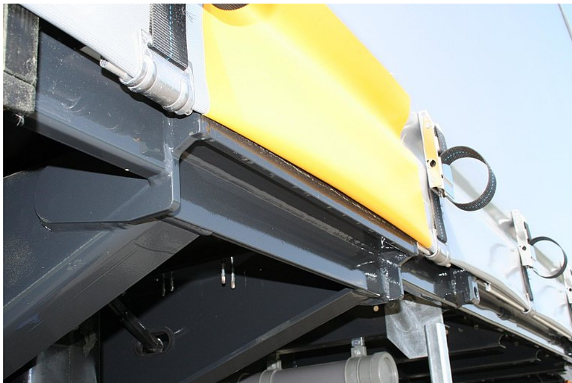
Erősített alvázfelépítés 4 fogadózseb, daruzható vasúti rakodáshoz
