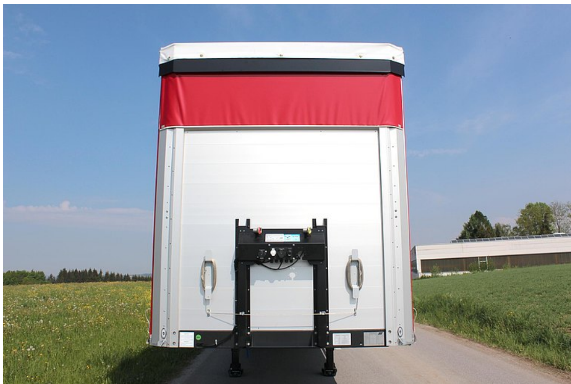
Erősített, üreges alumínium profil mellfal, aljzattartóval
