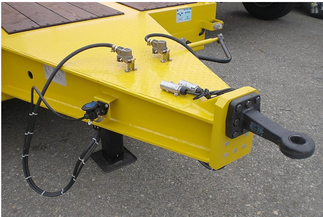
Rakfelület előtt elhelyezkedő vonóberendezés, csavarkötéssel rögzített vonószemmel
