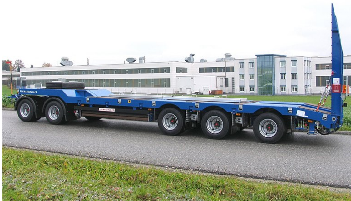
5-tengelyes, hajlított rakfelületű, nehézgépszállító pótkocsi
