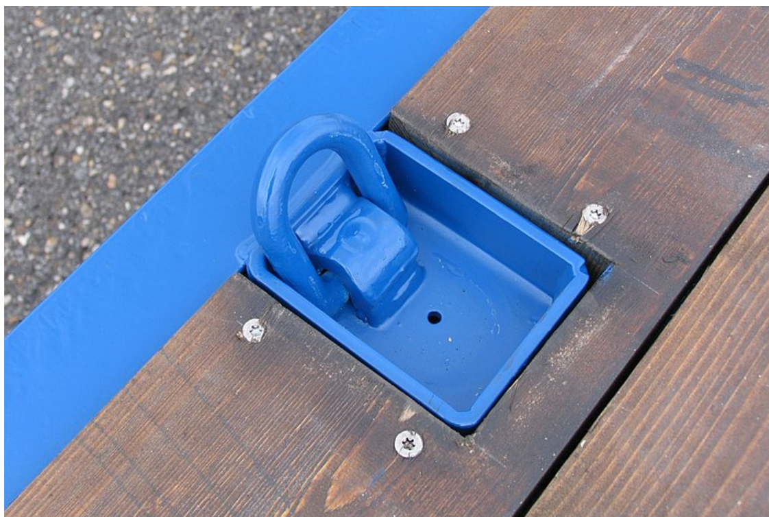
Padlóba süllyesztett lekötőgyűrű, valamint lekötőfűl a keretszegélyben az optimális rakományrögzítéshez
