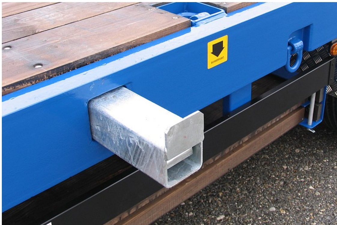
Kihúzható szélesítések pallókkal, túlméretes áruk szállítására
