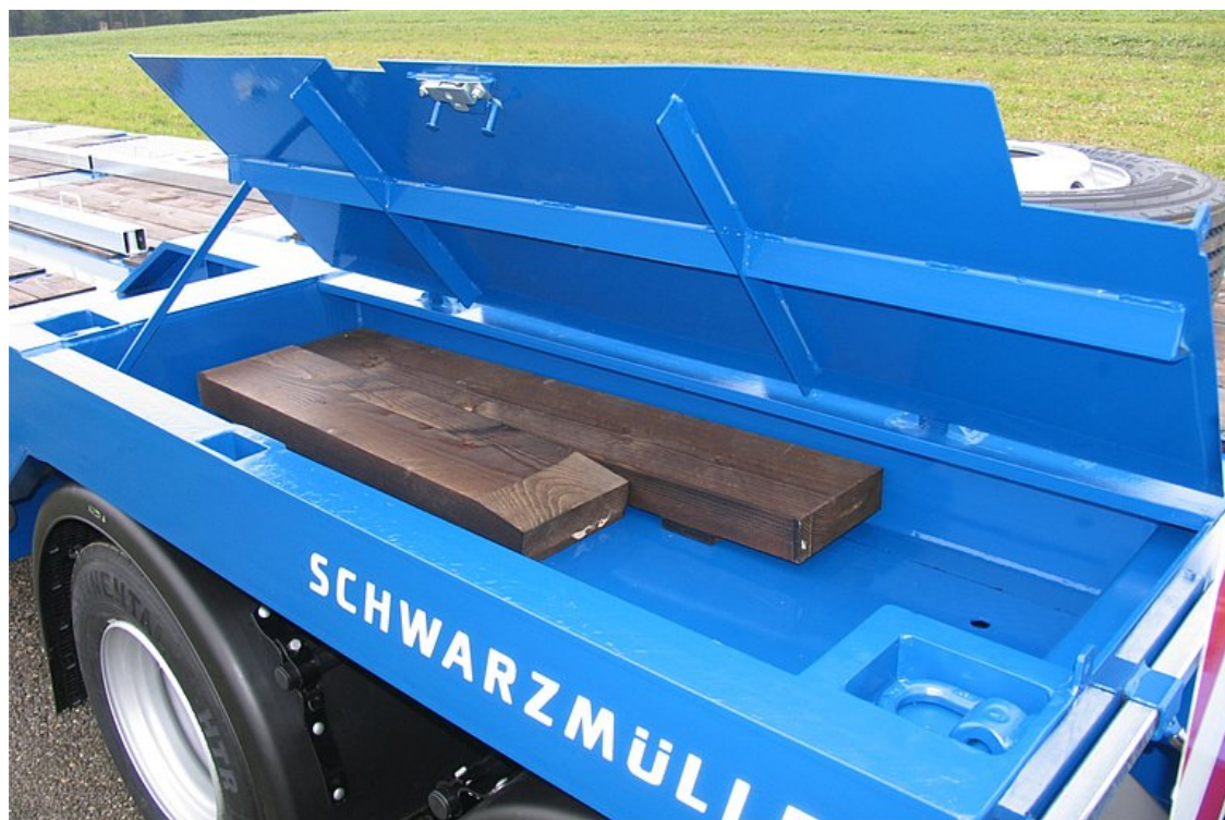
Magasított rakfelület, 2 zárható tartozékrekesszel
