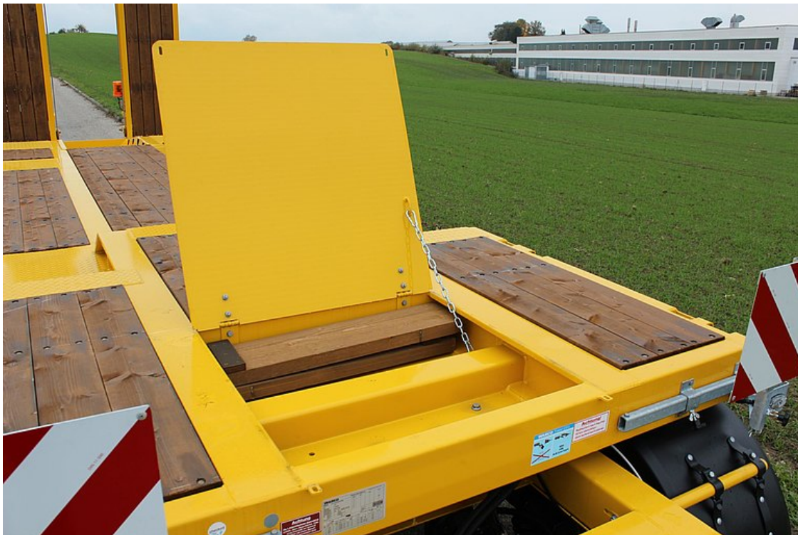
1 tárolórekesz - középen a rakfelület első részén, nyitható fedéllel
