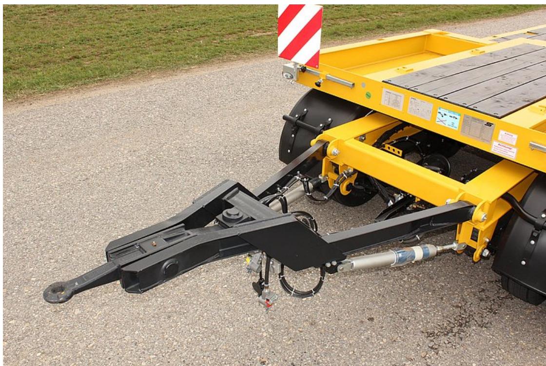
OPCIONÁLIS: hajlított vonóháromszög, állítható 40 + 50 mm vonószemmel
