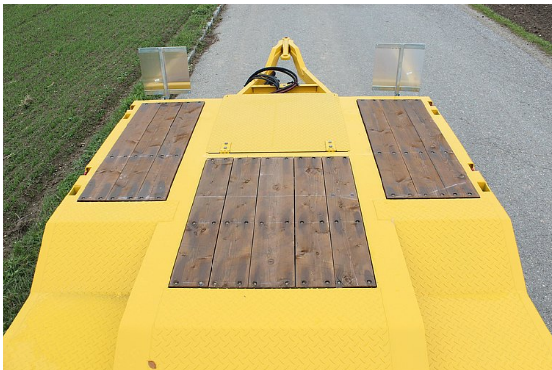
Elöl alvázhajlítással megemelt rakfelület, sarkoknál srégelve
