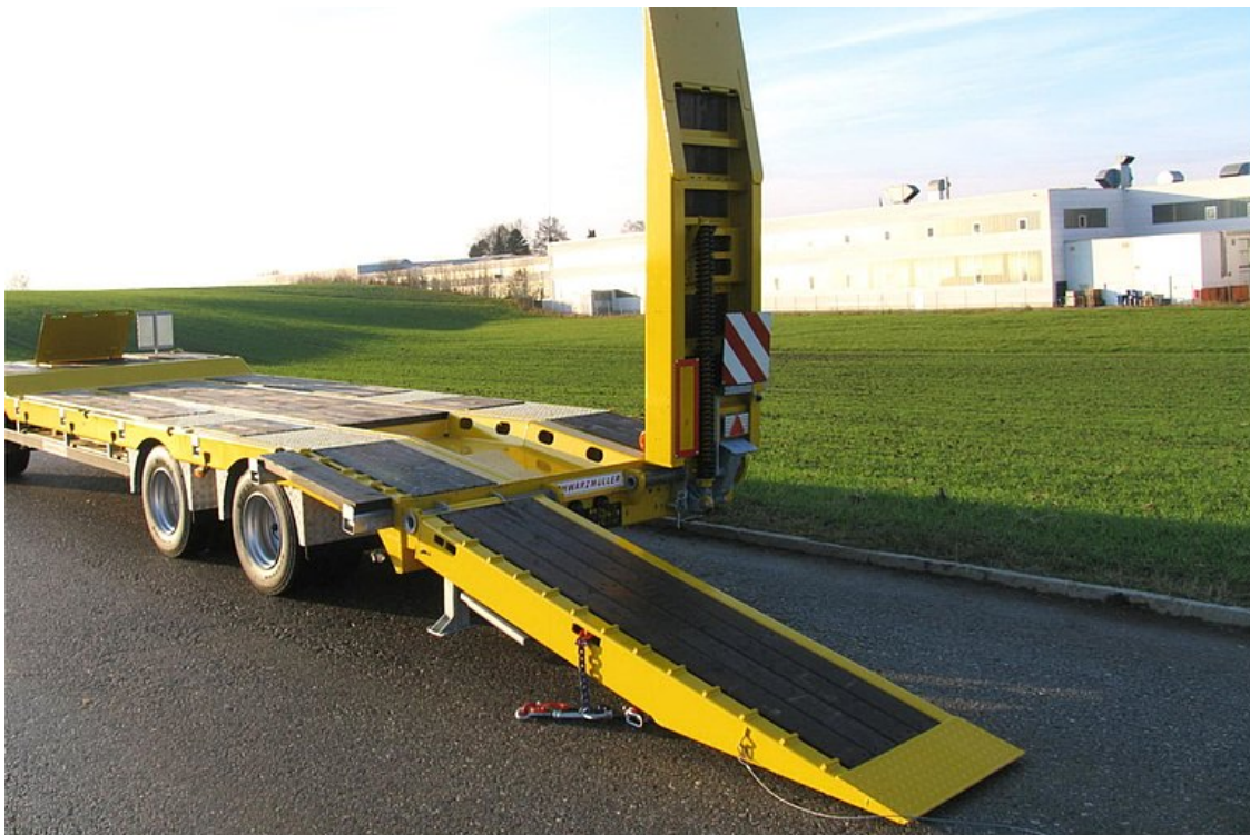
2 lehajtható, 1-részes felhajtórámpa keményfa betéttel
