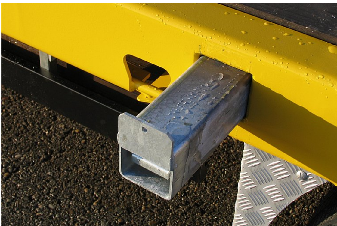
Kihúzható szélesítések pallókkal, túlméretes áruk szállítására
