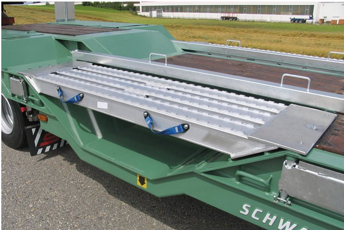
Kerékvályú a keretszegélyben, a padló kialakításhoz igazodva, átjárható alumínium fedéllel
