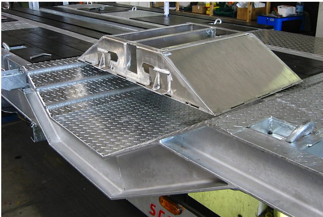
Különböző kialakítású kerékvályúk, a speciális munkagépek szállítására
