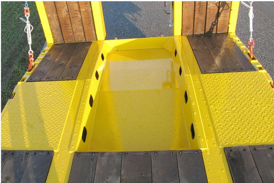
Markolókanál-vályú - mélyítés hátul a hosszstartók között
