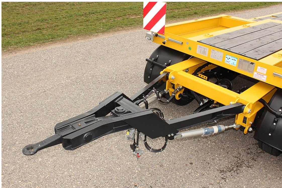
OPCIONÁLIS: hajlított vonóháromszög, állítható 40 + 50 mm vonószemmel
