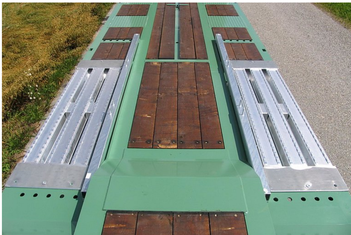
Kerékvályú átjárható alumínium fedéllel
