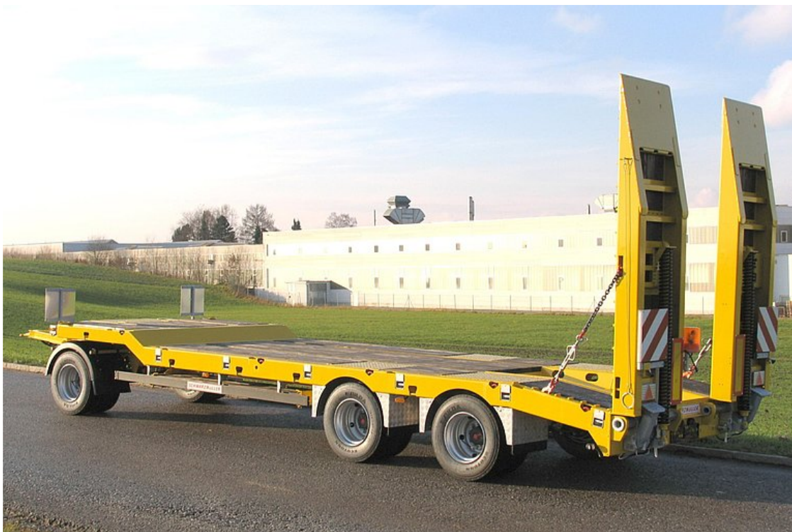
3-tengelyes, hajlított rakfelületű, nehézgépszállító pótkocsi
