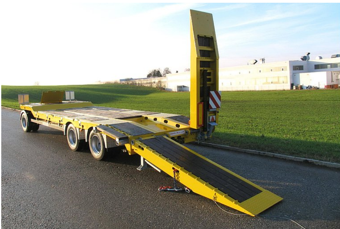
2 lehajtható, 1-részes felhajtórámpa keményfa betéttel
