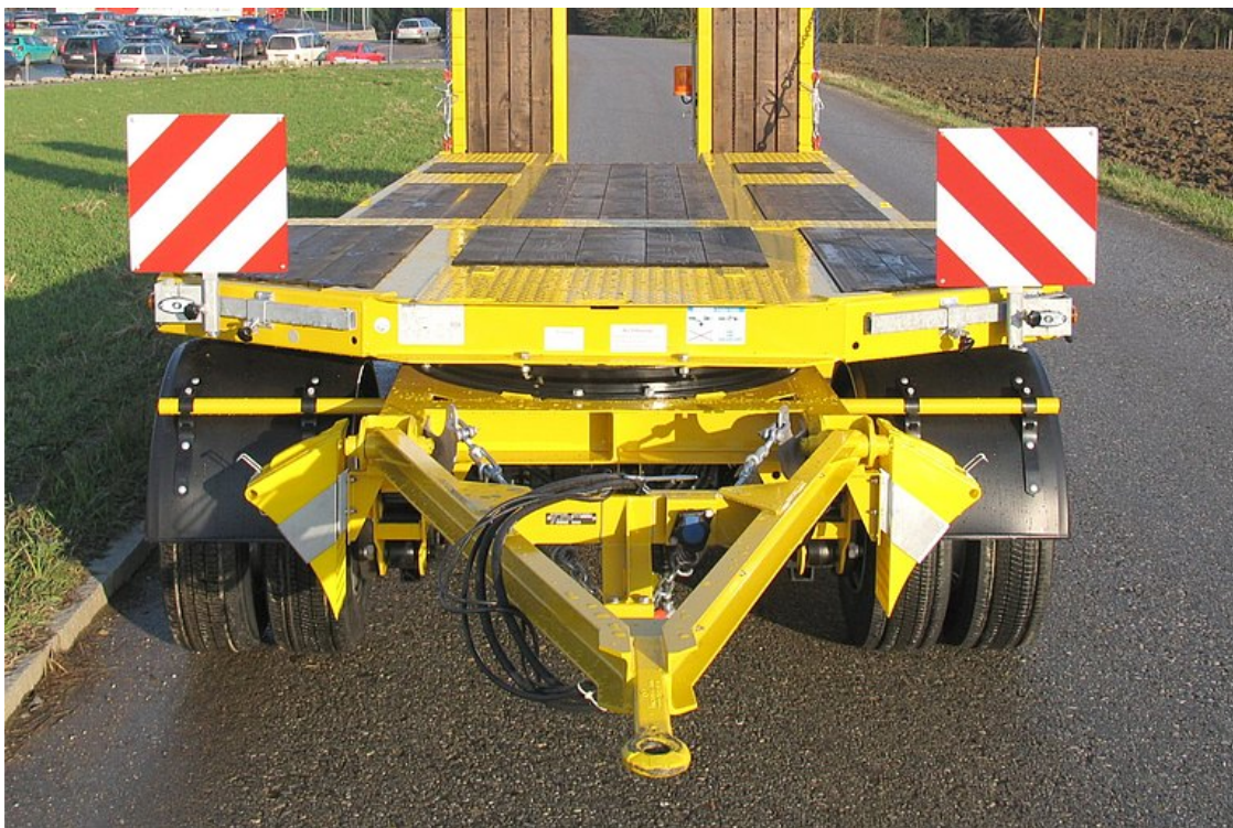
Forgósámoly és vonóháromszög, kihúzható figyelmeztető táblával
