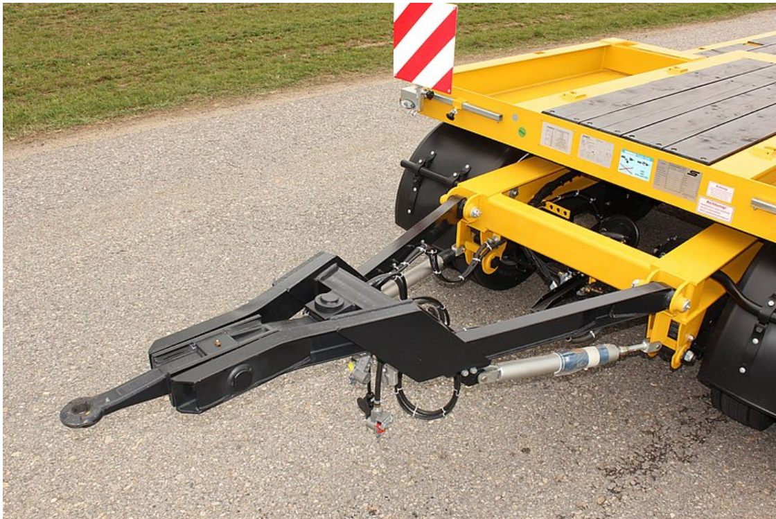
Hajlított vonóháromszög, állítható 40 + 50 mm vonószemmel
