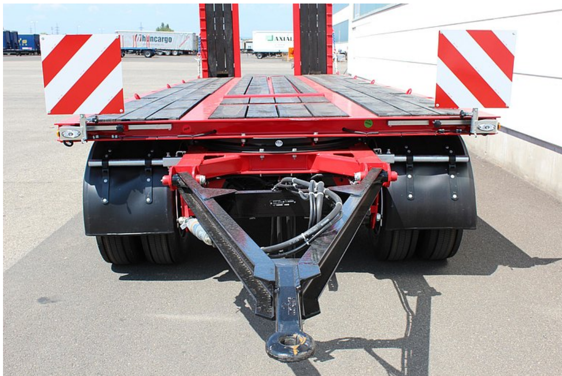
Forgózsámoly és vonóháromszög, kihúzható figyelmeztető táblával
