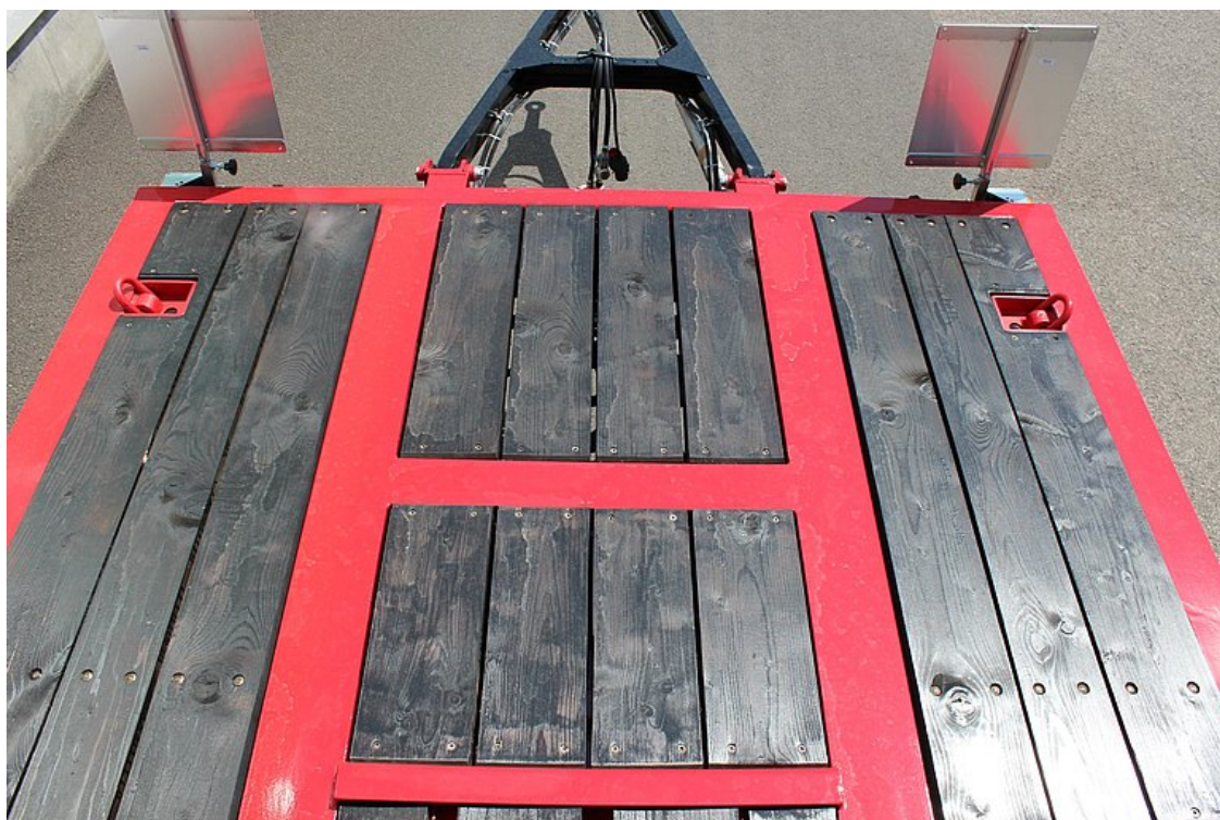
Impregnált puhafa padló, alvázprofilok fölé ér
