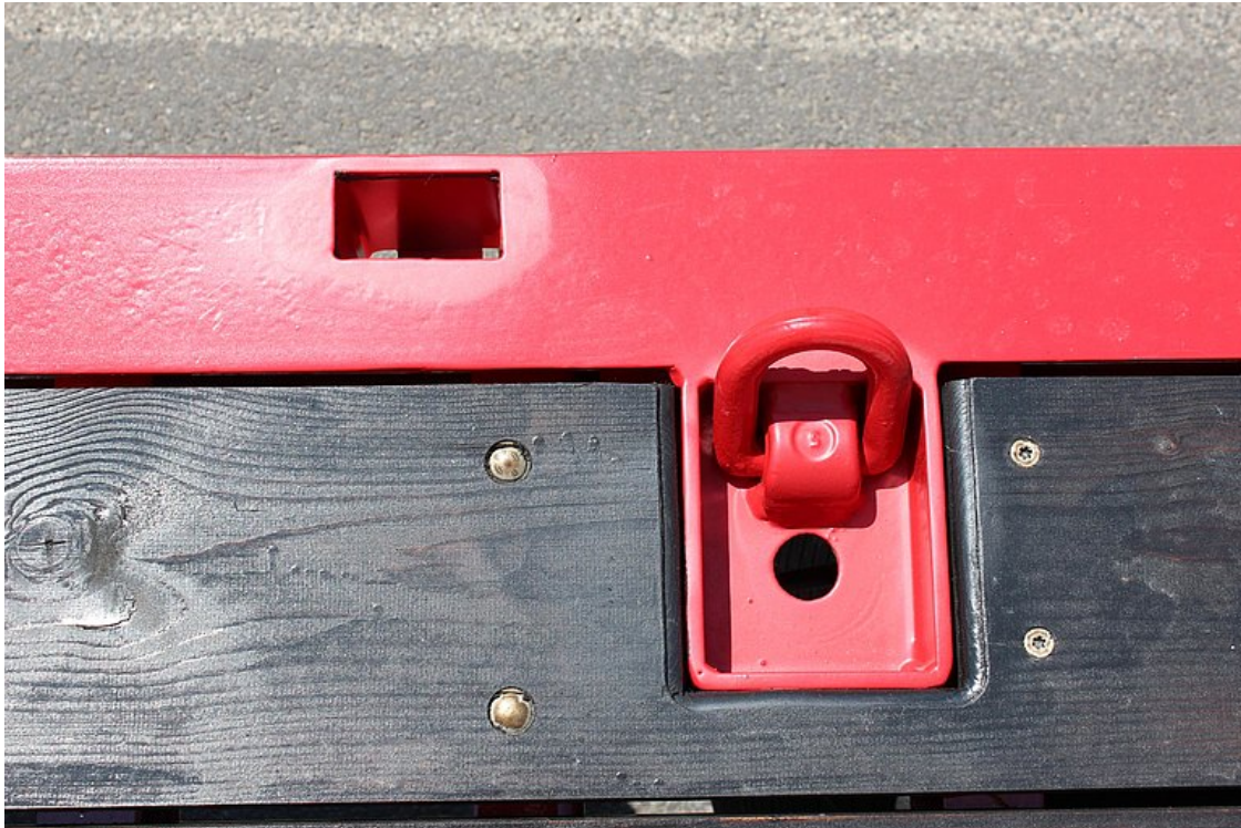
5 pár süllyesztett, felhajtható lekötőgyűrű
