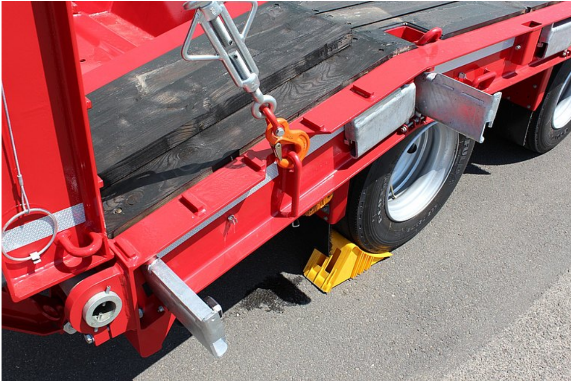
OPCIONÁLIS: kihajtható, kiforgatható szélesítések pallókkal, túlméretes áruk szállítására
