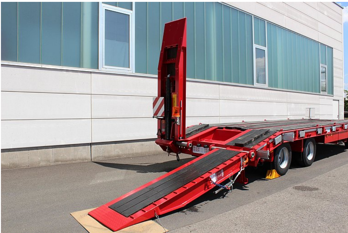
2 lehajtható, 1-részes felhajtórámpa keményfa betéttel
