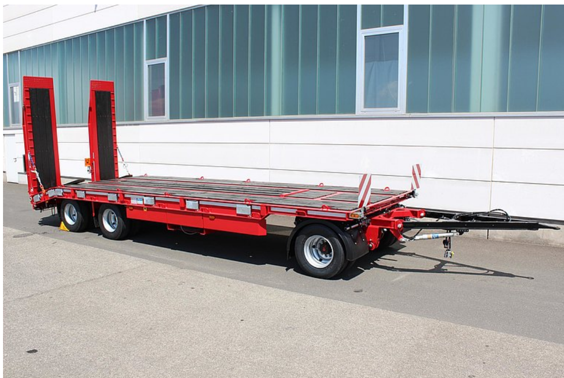
3-tengelyes, egyenes rakfelületű, nehézgépszállító pótkocsi
