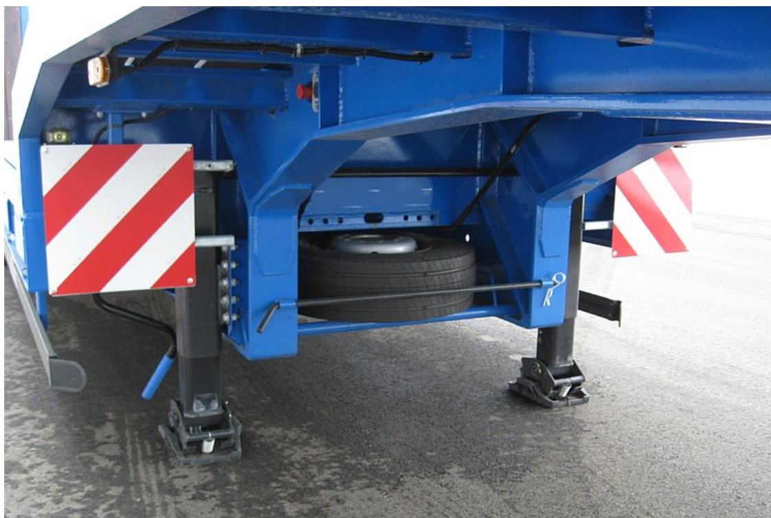
Hegesztett acélkonstrukció - magas pontszerű terhelés a sűrű elrendezésű kereszttartóknak köszönhetően
