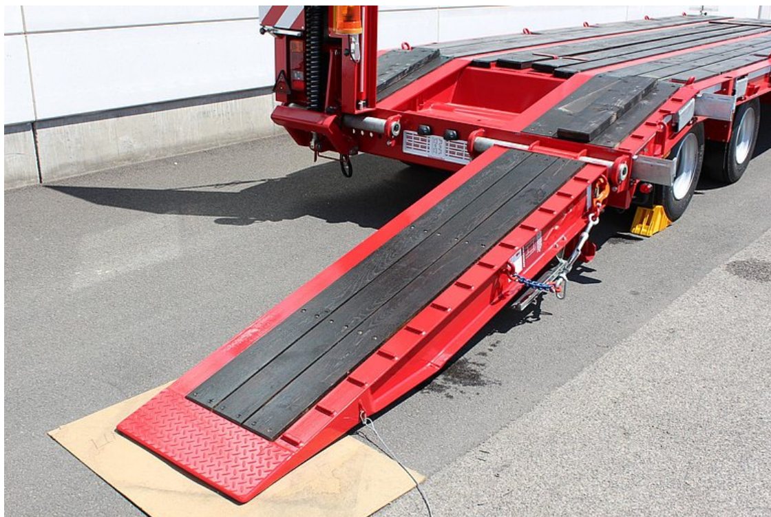
Felhajtórámpák keményfa padlóval és felhegesztett négyszögbordákkal
