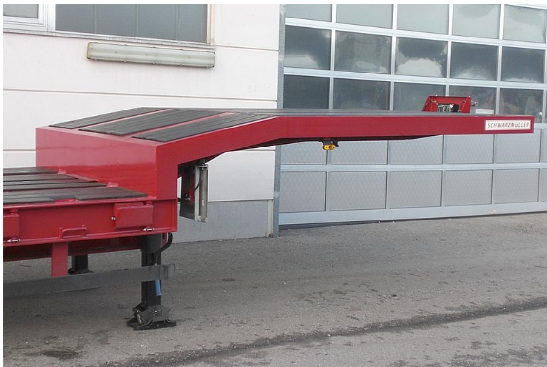
Elöl alvázhajlítással megemelt rakfelület
