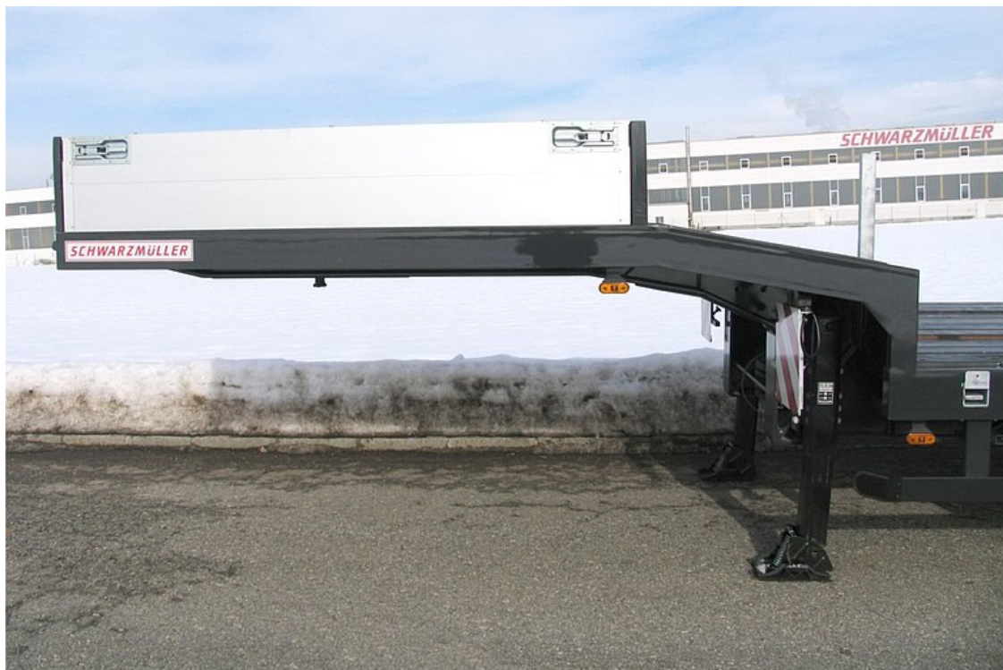
Elöl alvázhajlítással megemelt rakfelület, betűzhető oldalfalakkal
