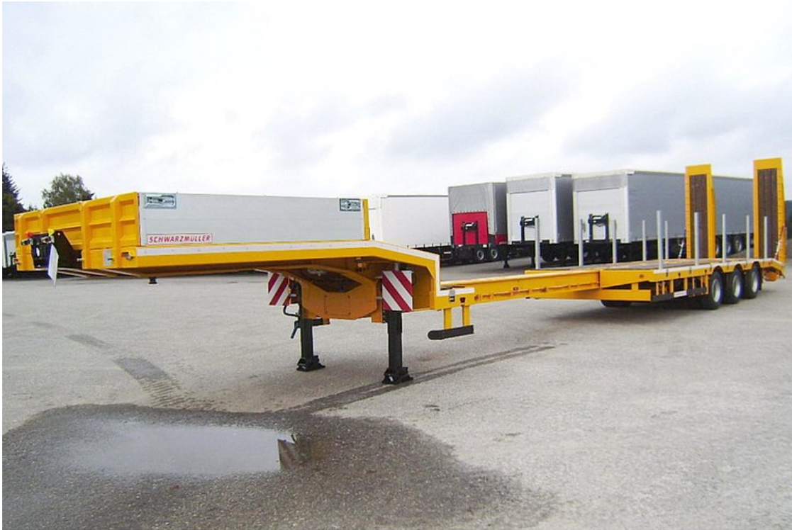
3-tengelyes, nehézszállító félpótkocsi - erősített - kihúzható
