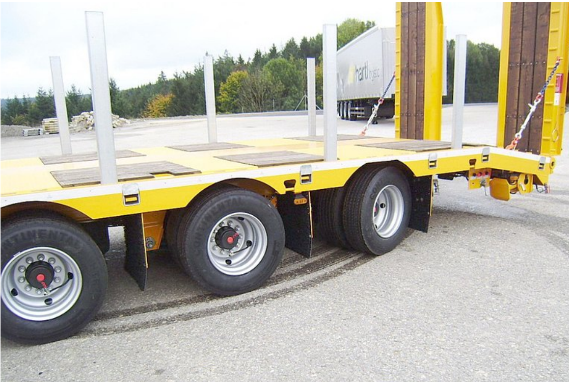
3. tengely talajkormányzott a jobb kanyarodás és a gumiabroncsok kímélése érdekében
