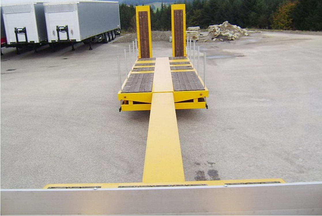
Mélyágys rakfelület puhafa padlóval és rakoncákkal a keretszegélyben
