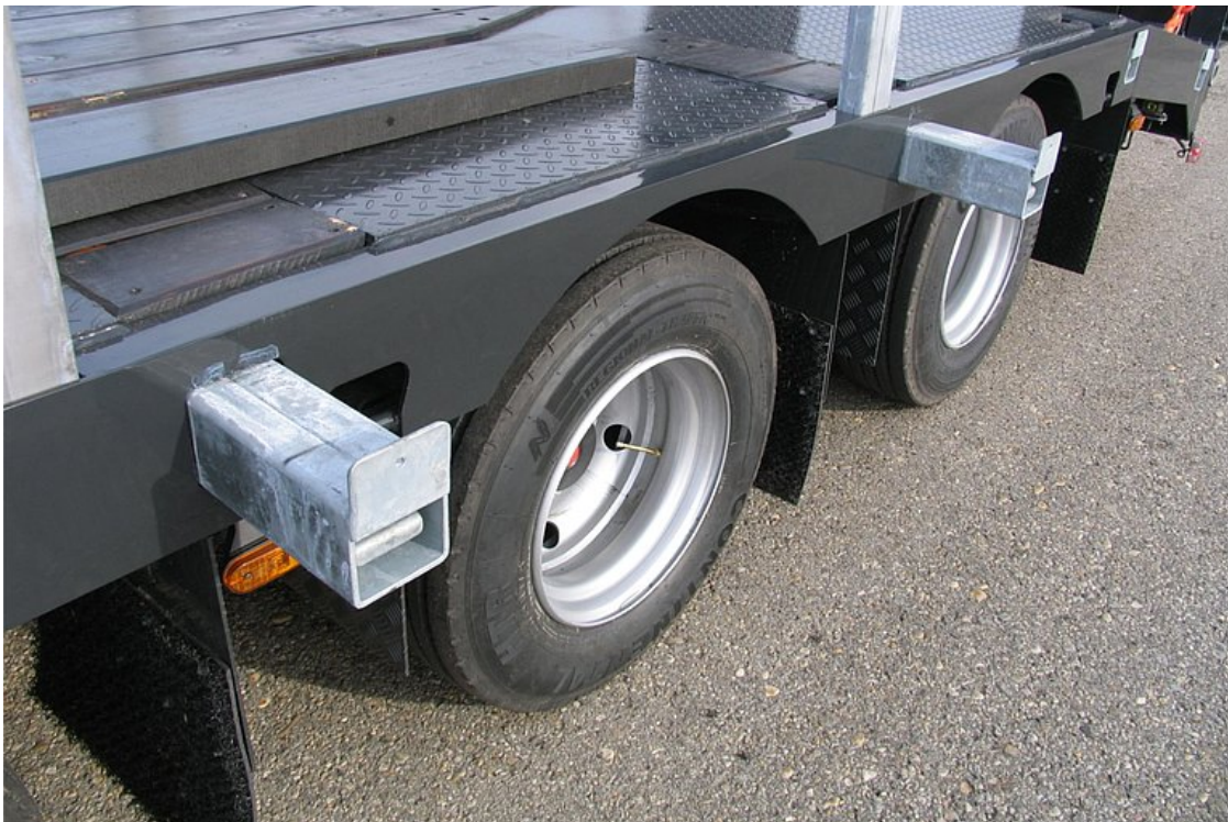
Kihúzható szélesítések pallókkal, túlméretes áruk szállítására
