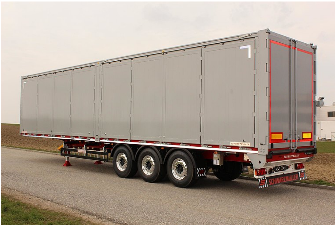
3-tengelyes, mozgópaddós félpótkocsi, oldalsó ajtókkal
