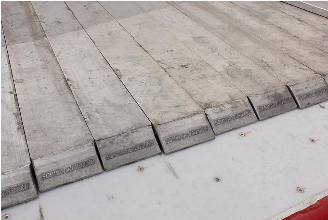
Cargoflor-mozgópádó, hidraulikusan mozgatható 21-profilos rendszer, a ki- és berakodáshoz
