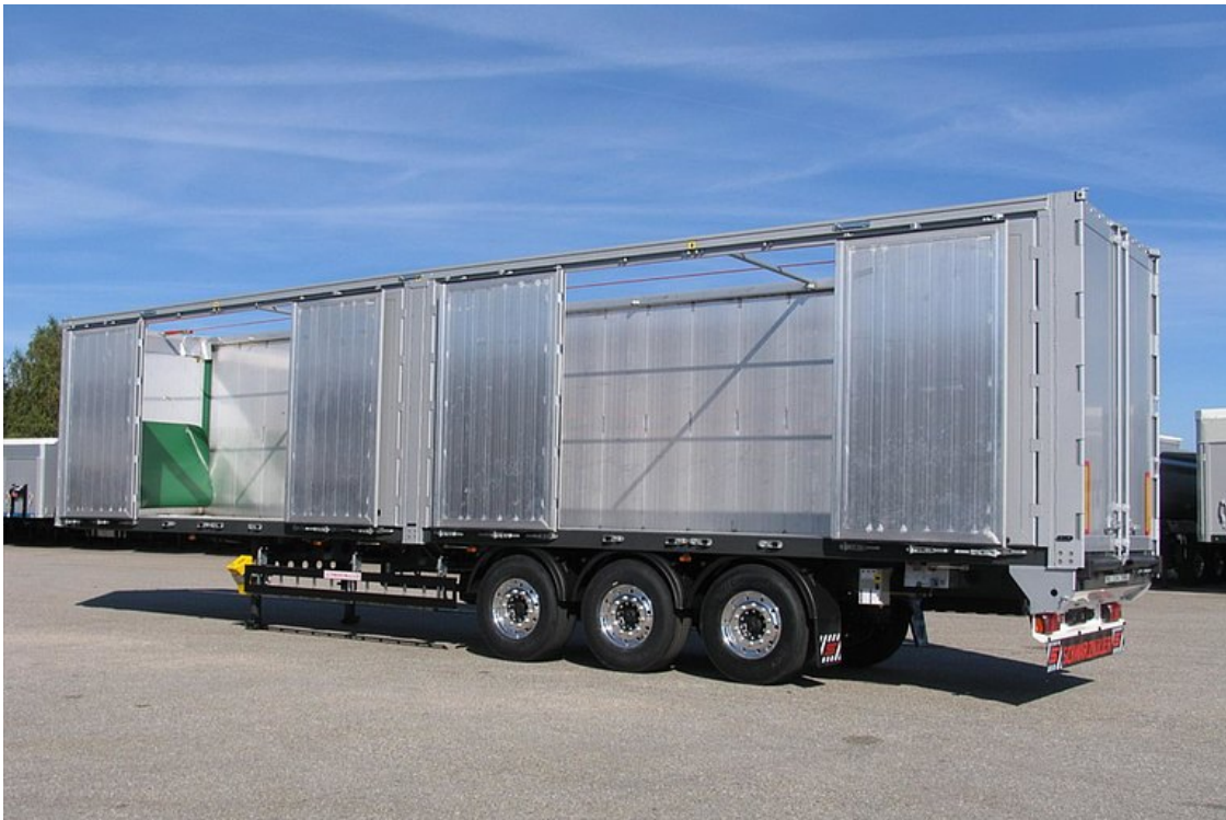
Bal oldalon 2 négyszárnyú ajtó, oldalról történő rakodáshoz
