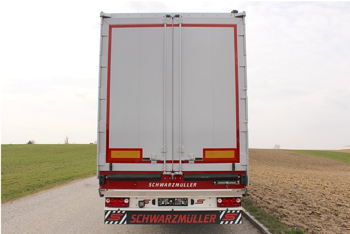
Hátfal = kétszárnyú teliajtó, ajtószárnyanként 1 rúdzárral, pneumatikusan vezérelt biztonsági reteszelés
