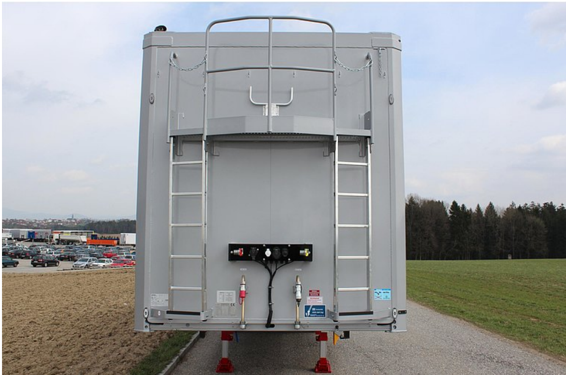
Rögzített, üreges alumínium profil mellfal, felül merevítéssel
