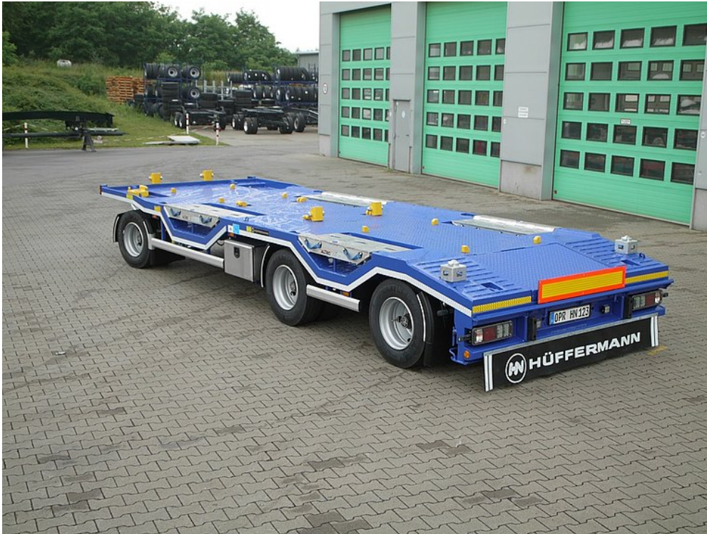
Különleges kivitel kerékvályúkkal, ISO-konténerhez és láncos konténerhez
