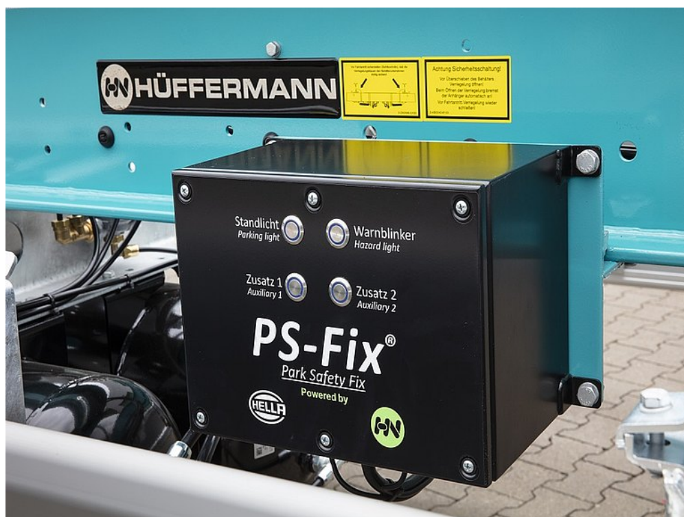
OPCIÓ: önálló világítási rendszer a fokozott biztonságért
