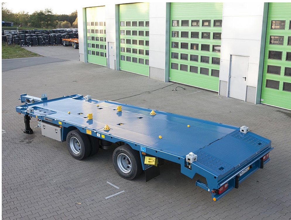
Különleges kivitel ISO-konténer felfogatással
