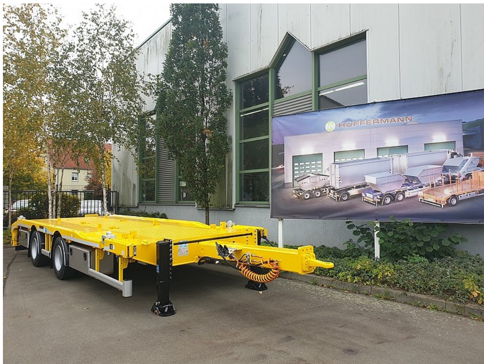
Különleges kivitel ISO-konténer felfogatással
