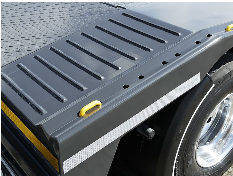
Süllyesztett és áthelyezhető rögzítési pontok a keretszegélyen
