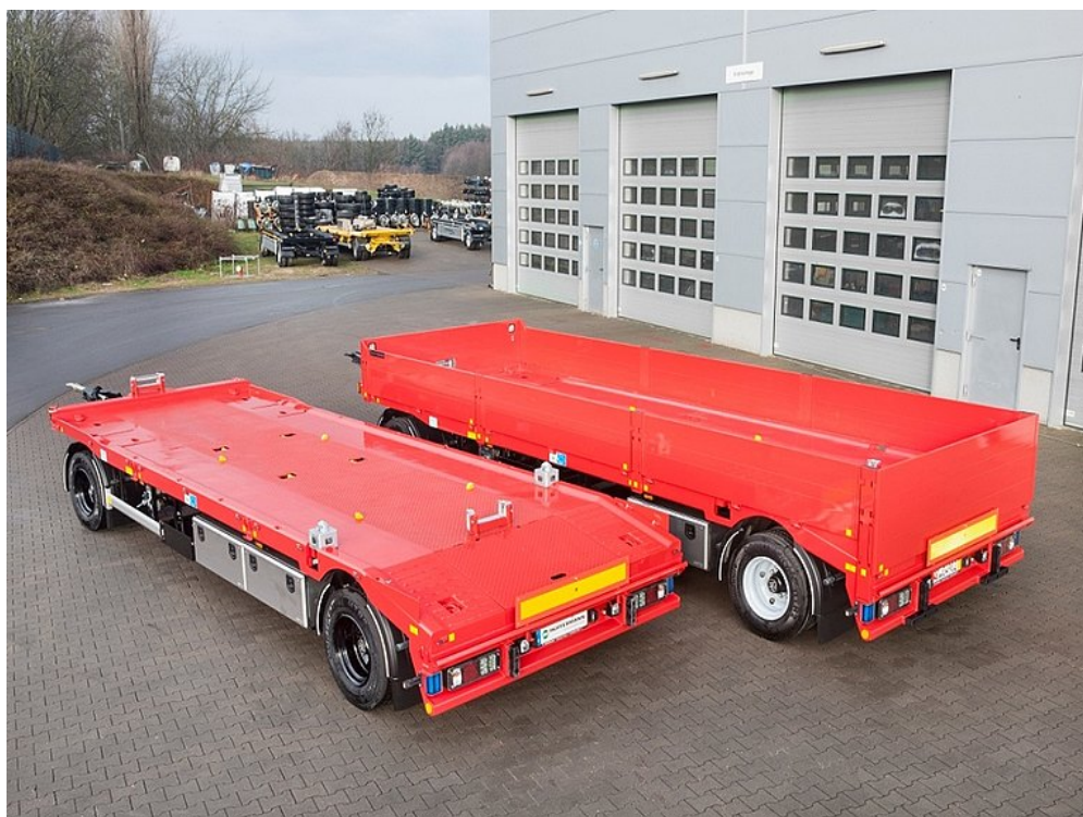
OPCIÓK: balra: ISO-konténer felfogatás, kötélcsörliő-nyílás, jobbra: alumínium oldalfalak
