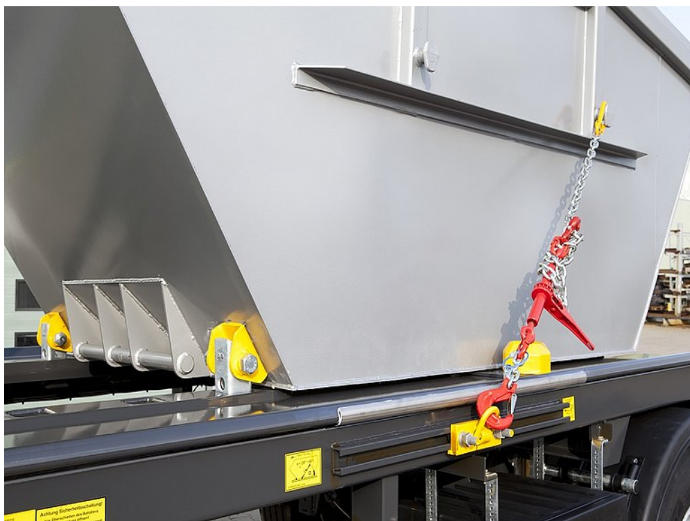
Kombinált rakományrögzítés Zentrier-Fix rendszerrel és kötözőláncokkal
