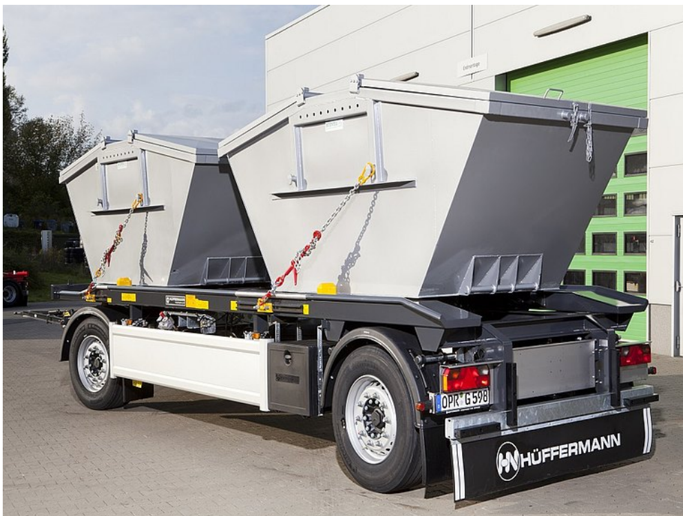
Kombinált rakományrögzítés Zentrier-Fix rendszerrel és kötözőláncokkal
