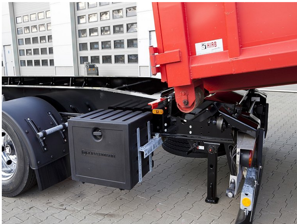
Hátsó támasztóláb a biztonságos konténeráthelyezéshez
