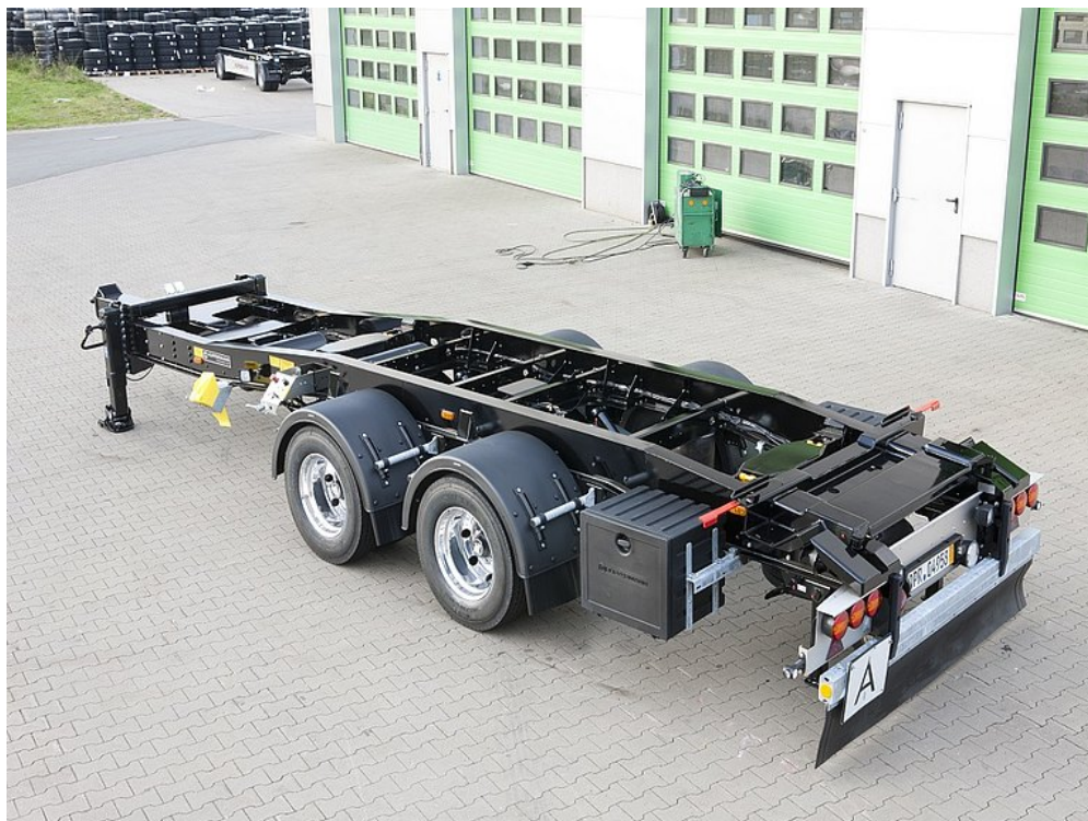
Különleges kivitel - 3 db LED-es kerek lámpa és fényezett csúszószán
