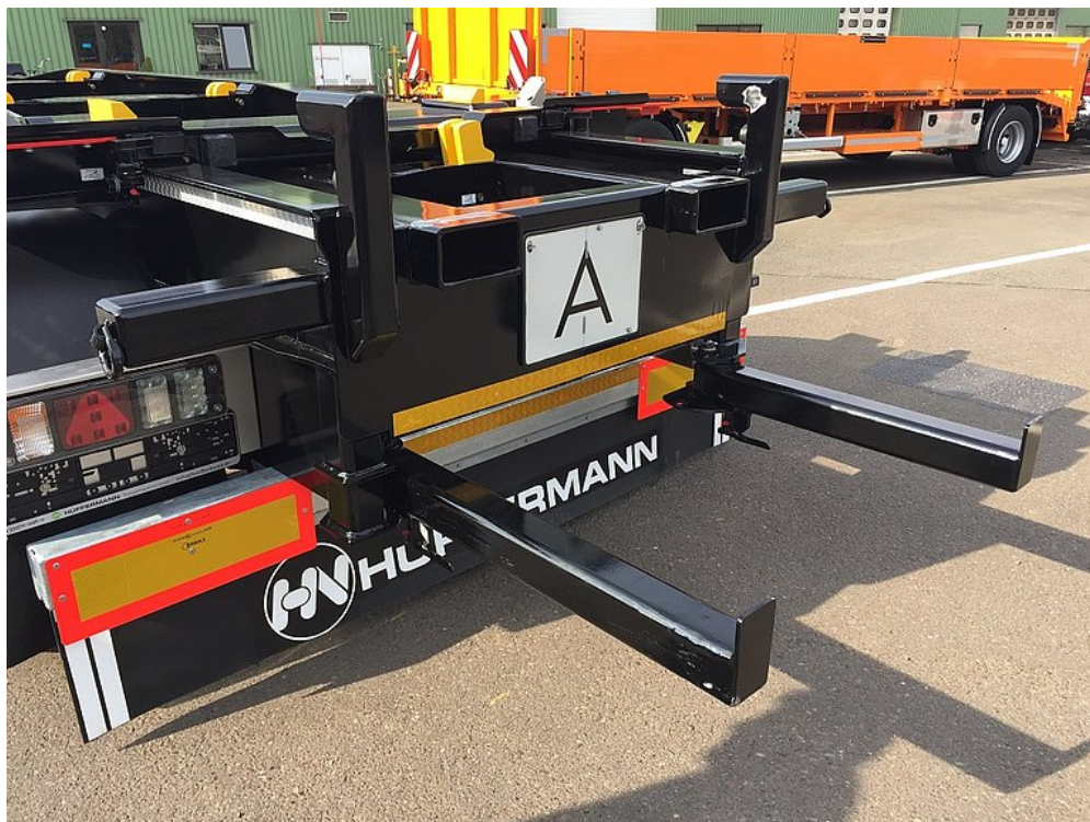
Előlről rakodható kivitel targoncaszállító résszel
