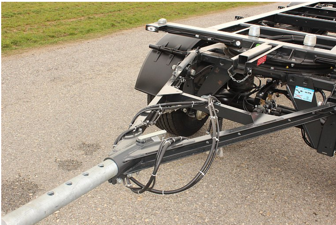
Kihúzható vonóháromszög, max. állíthatóság 600 mm, Getofix-alátámasztó
