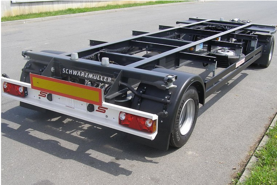
2-tengelyes, alacsony rakfelületű, cserefelépítmény szállító pótkocsi
