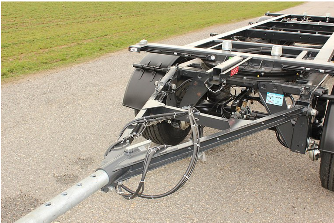
OPCIONÁLIS: kihúzható vonóháromszög, max. állíthatóság 600 mm, Getofix-alátámasztó
