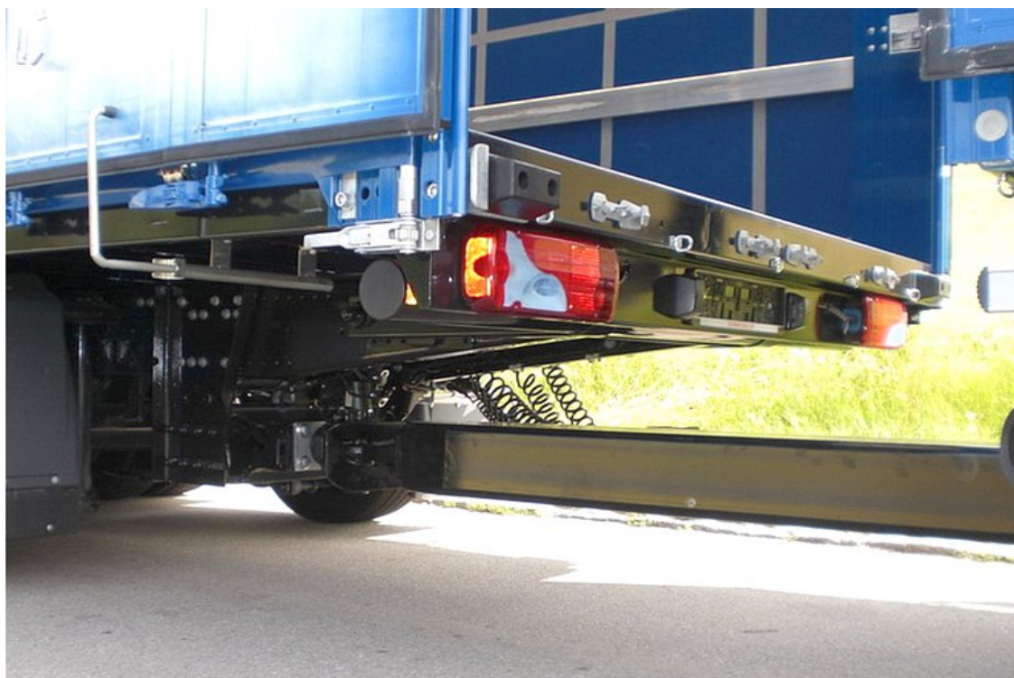
Különleges vonófej kialakítás tandem pótkocsikhoz
