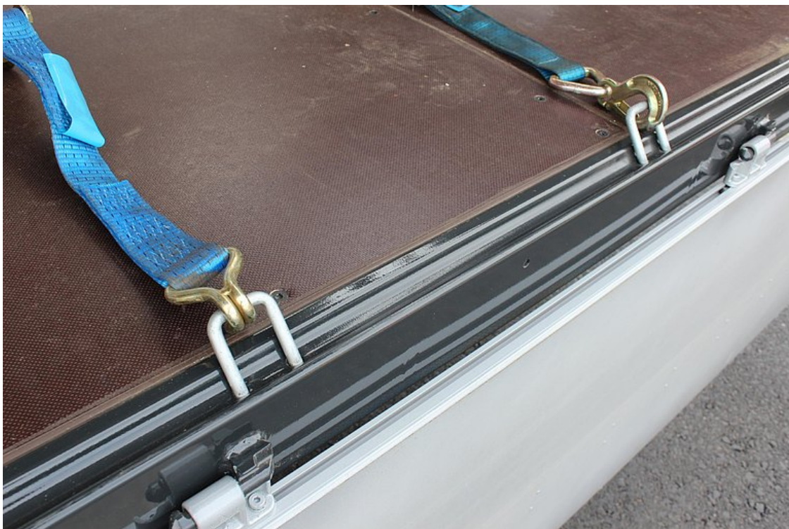
Lekötőgyűrűs keretszegély süllyesztett 2,5 t lekötőgyűrűvel
