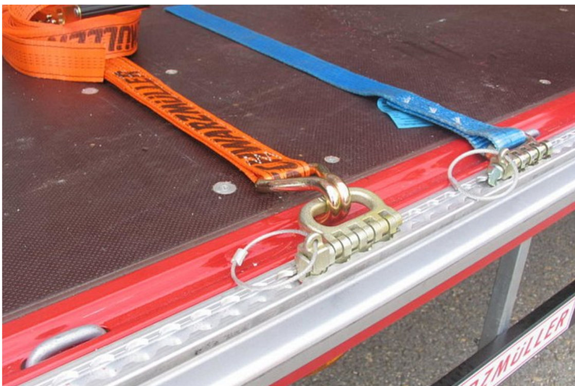
OPCIONÁLIS: variálható rakományrögzítés, felcsavarozható rögzítő-rendszerek segítségével - pl.: Airline rögzítőcsín
