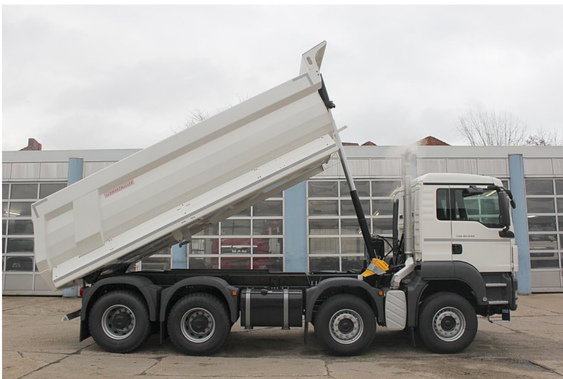
Hátra billenő, szegmentívű acél felépítmény 4-tengelyes járóképes alvázra
