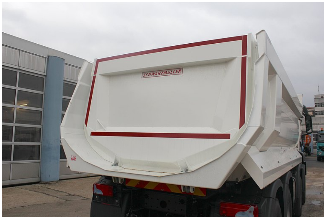
Kibillenő acél hátfal = süllyesztett csapágyazással
