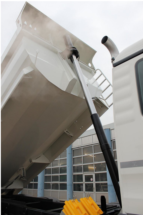
Magas minőségű, krómozott munkahenger
