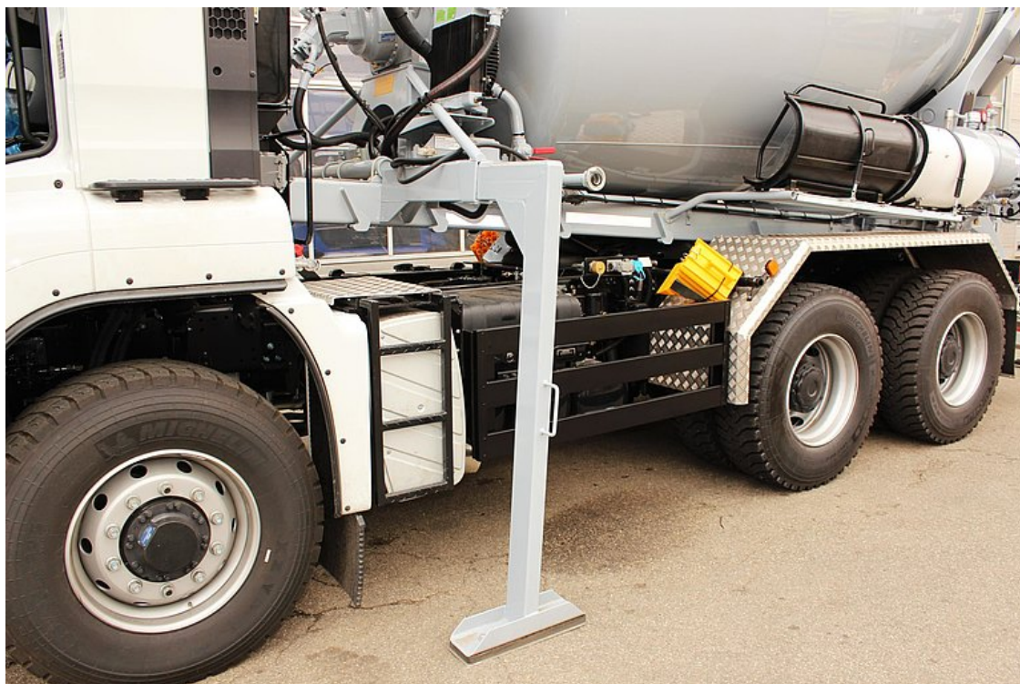
Elülső letalpalók a felépítmény gyors és egyszerű cseréjéhez
