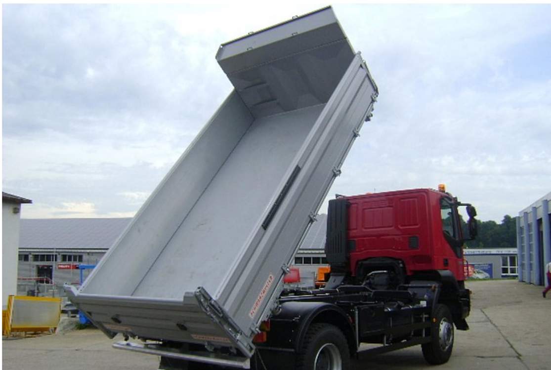
3-oldalra billenő felépítmény, 2-tengelyes járóképes alvázra - építőipari kivitel
