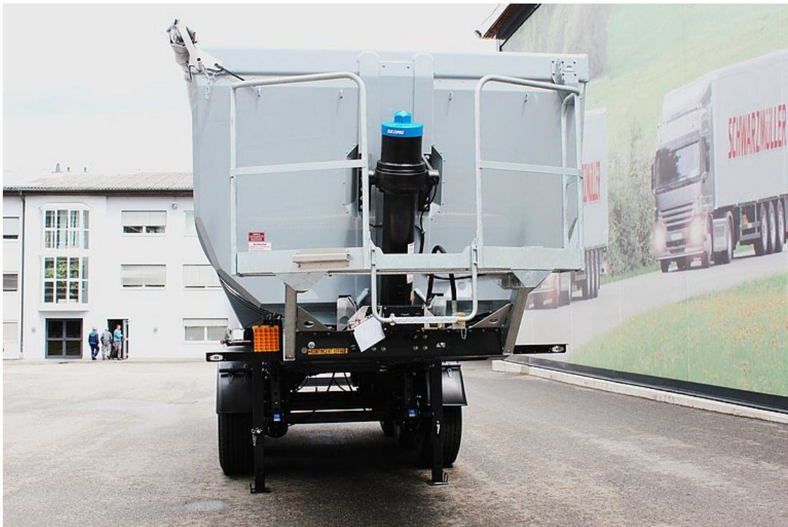
Izolált mellfal, magas minőségű krómozott munkahengerrel
