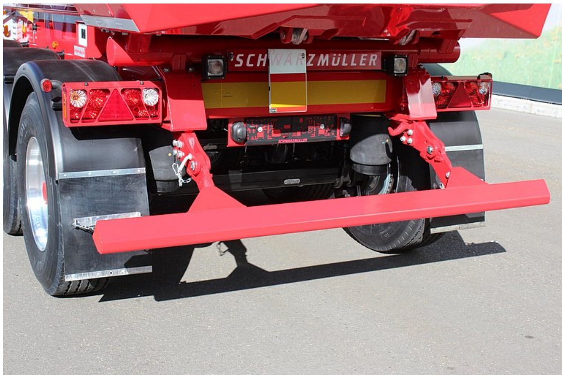
Felhajtható alumínium trapézprofil hátsó aláfutásgátló, opcionálisan pneumatikus működtetés
