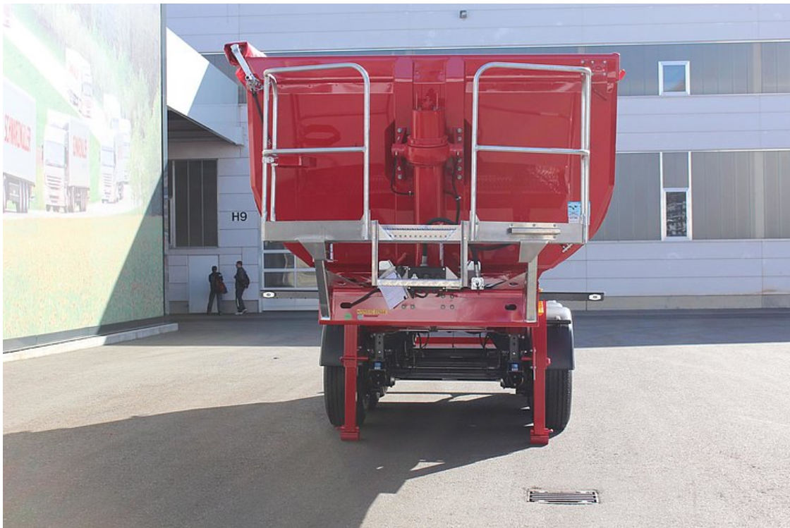
Izolált mellfal, magas minőségű krómozott munkahengerrel
