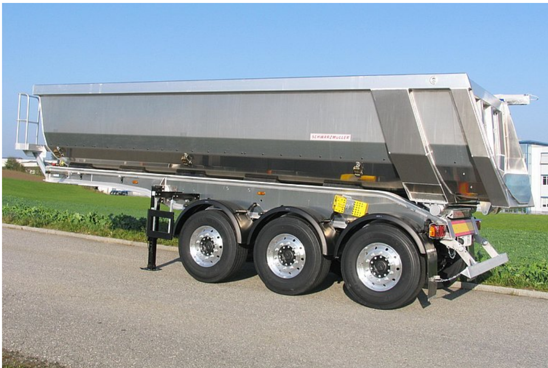
3-tengelyes, hátrabilenő, teljesen alumínium félpótkocsi, szegmentívű alumínium puttonnyal
