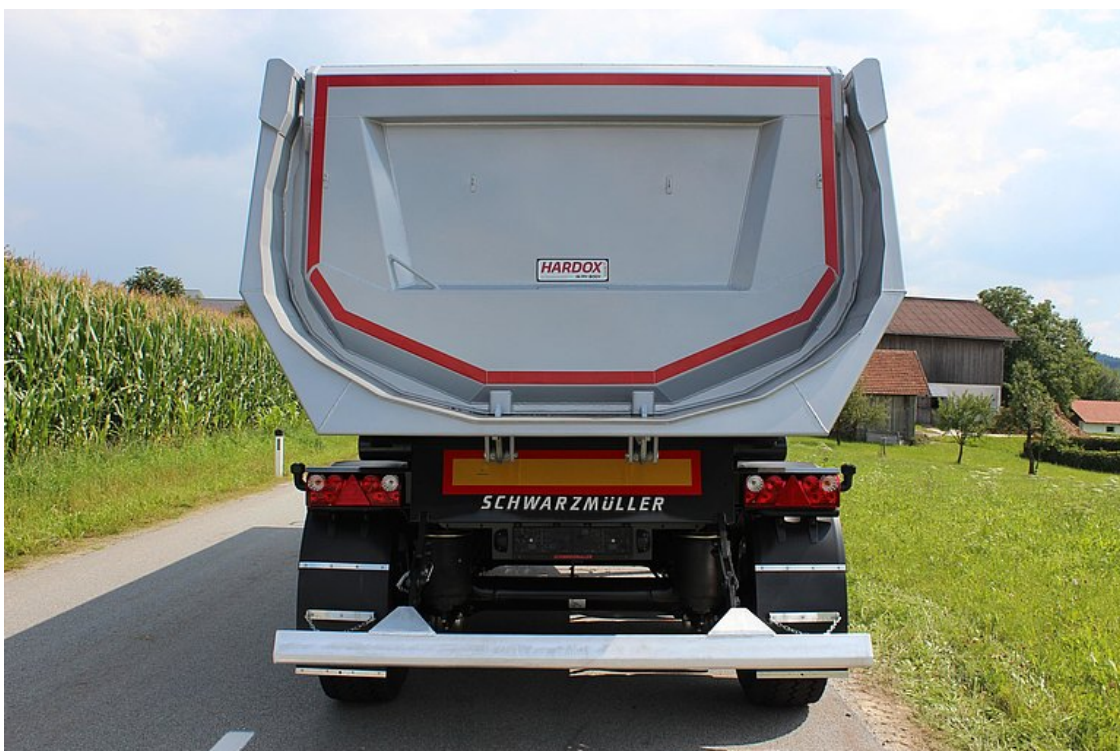
Kibillenő acél hátfal = süllyesztett csapágyazással és automatikus-mechanikus 2-kampós központi reteszeléssel
