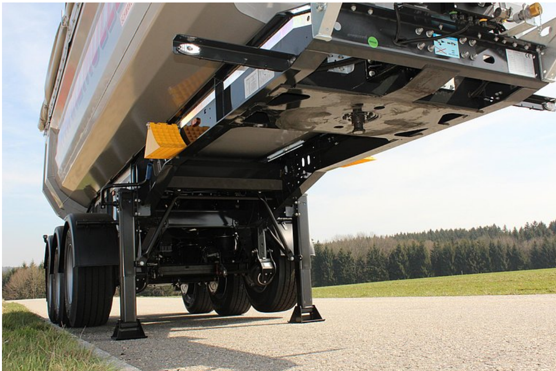
Stabil és csavarodásálló alvázkonstrukció, torzióscsövekkel kiegészítve
