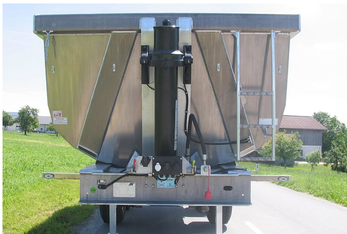
Ferde kivitelű mellfal, magas minőségű krómozott munkahengerrel
