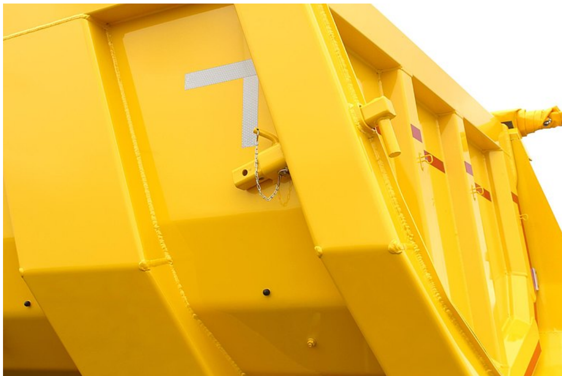
OPCIONÁLIS: adagolórendszer kibillenő hátfalhoz, kihúzható ütközővel
