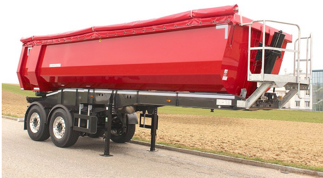
2-tengelyes, hátrabilenő félpótkocsi, szegmentívű alumínium puttonnyal
