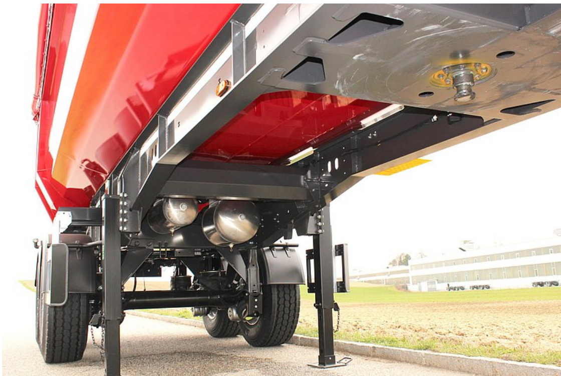
Stabil és csavarodásálló alvázkonstrukció, torzióscsövekkel kiegészítve
