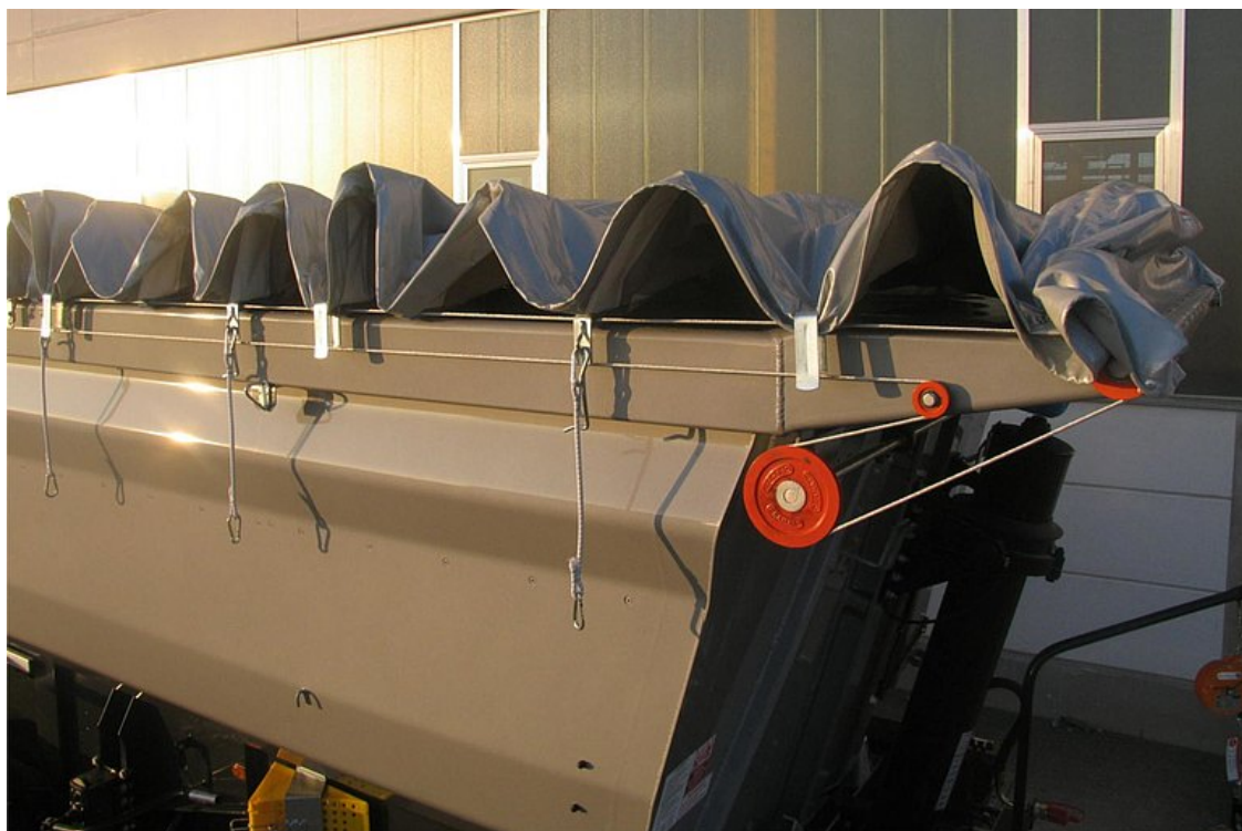
OPCIONÁLIS: rolós tetőszerkezet - manuális vagy elektromos távvezérléssel kezelhető
