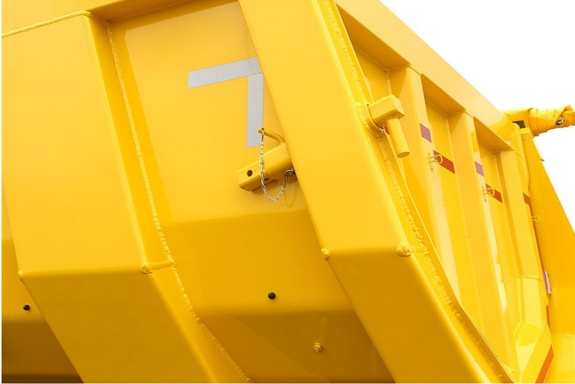
OPCIONÁLIS: adagolórendszer kibillenő hátfalhoz, kihúzható ütközővel
