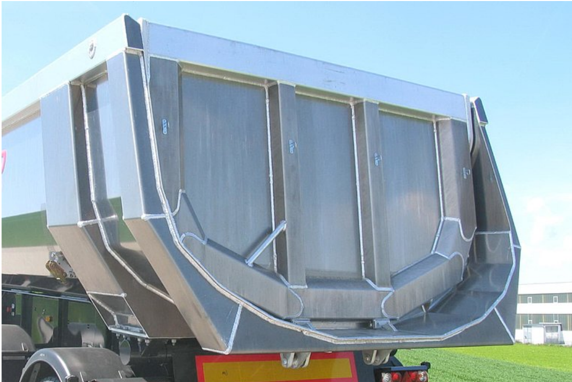
Hátfal = billenő kivitel, süllyesztett csapágyazással és auto-mechanikus dupla zárral
