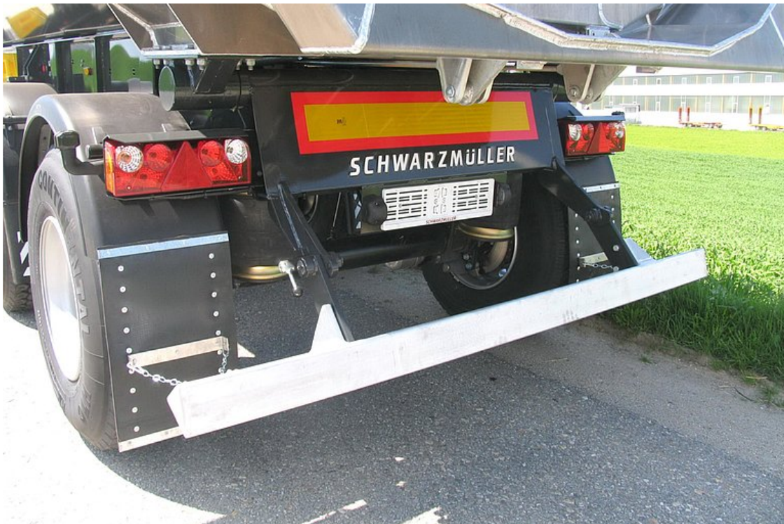
Felhajtható, alumínium trapézprofil hátsó aláfutásgátló
