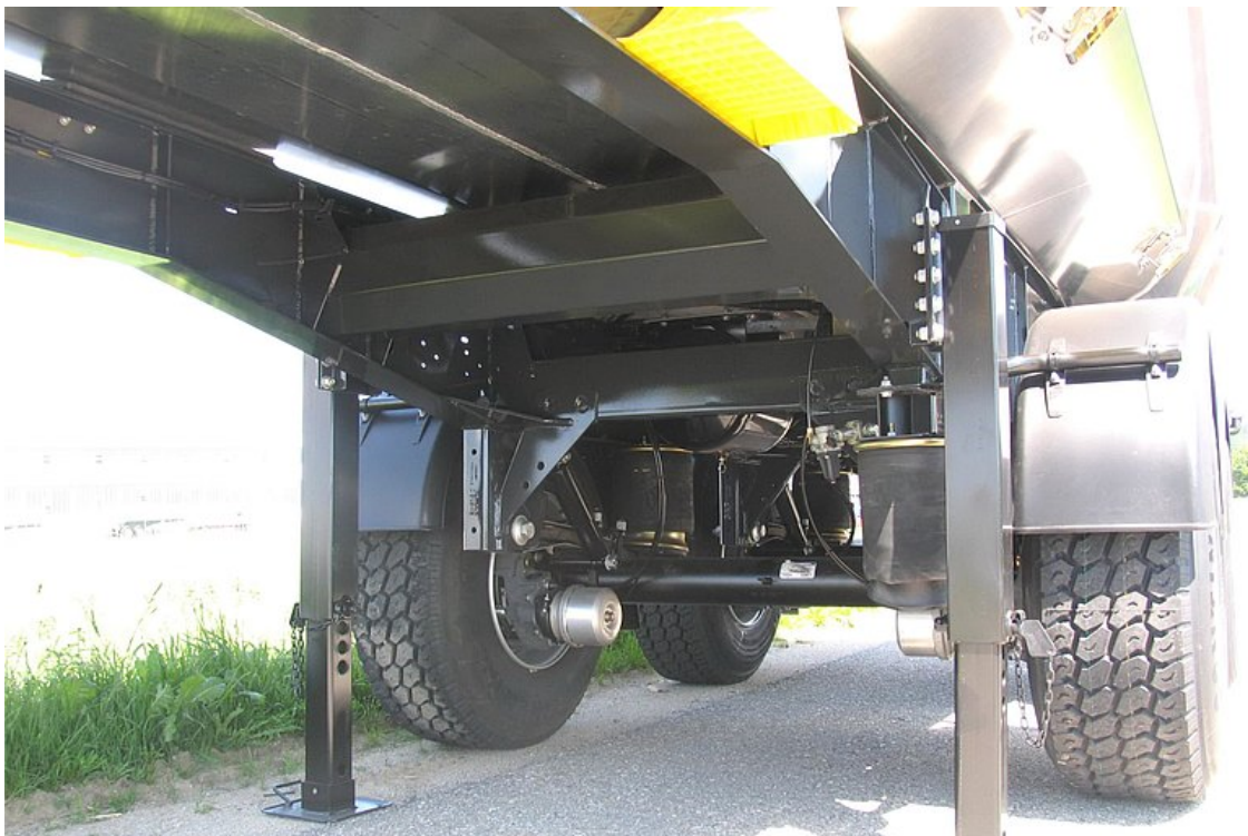
Stabil és csavarodásálló alvázkonstrukció, torziócsövekkel kiegészítve
