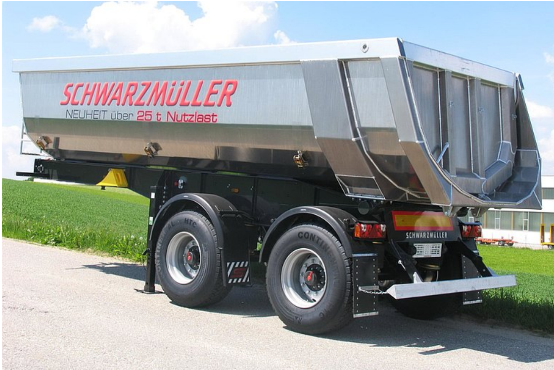
2-tengelyes, hátrabilenő félpótkocsi, szegmentívű alumínium puttonnyal - tengelytáv 1.810 mm
