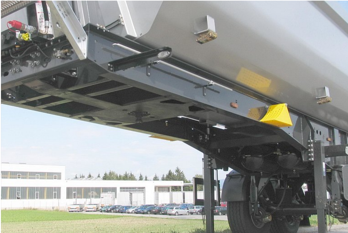
Stabil és csavarodásálló alvázkonstrukció, torzióscsövekkel kiegészítve
