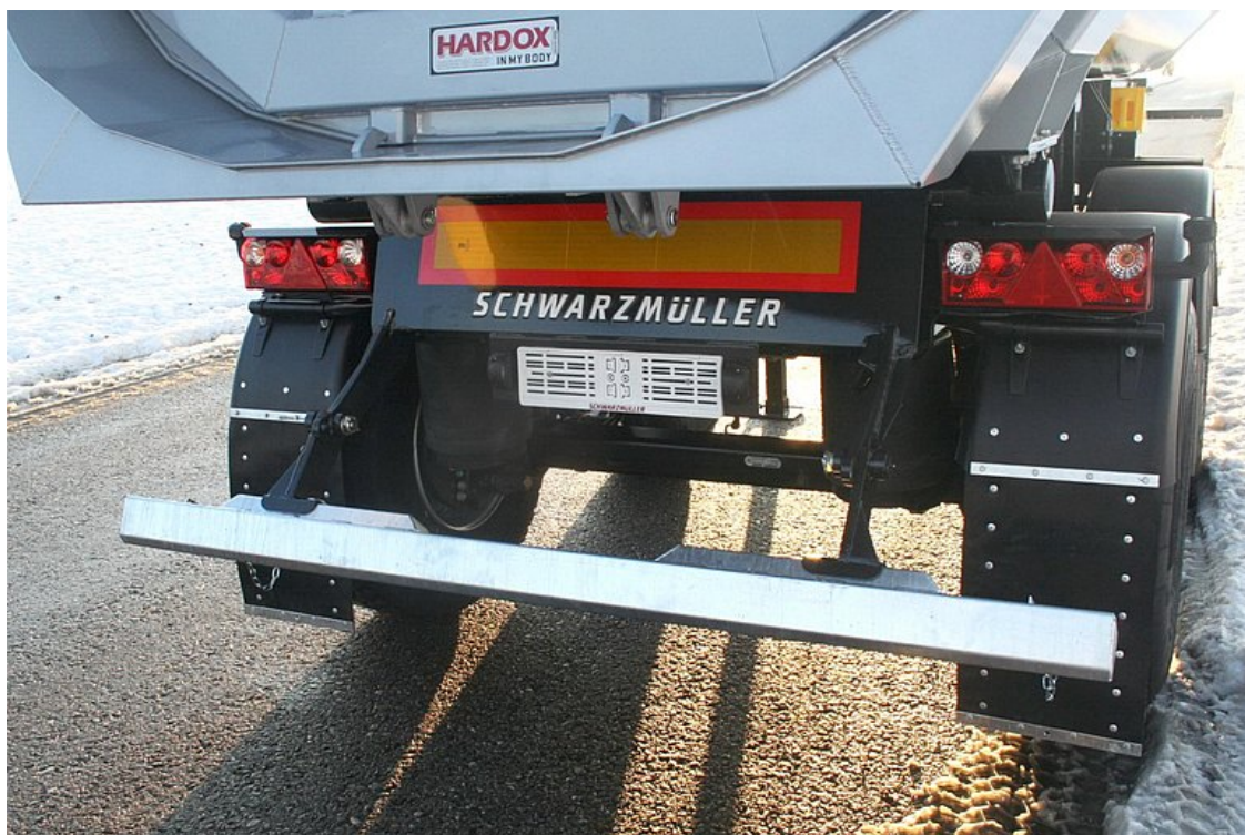
Felhajtható, alumínium trapézprofil hátsó aláfutásgátló
