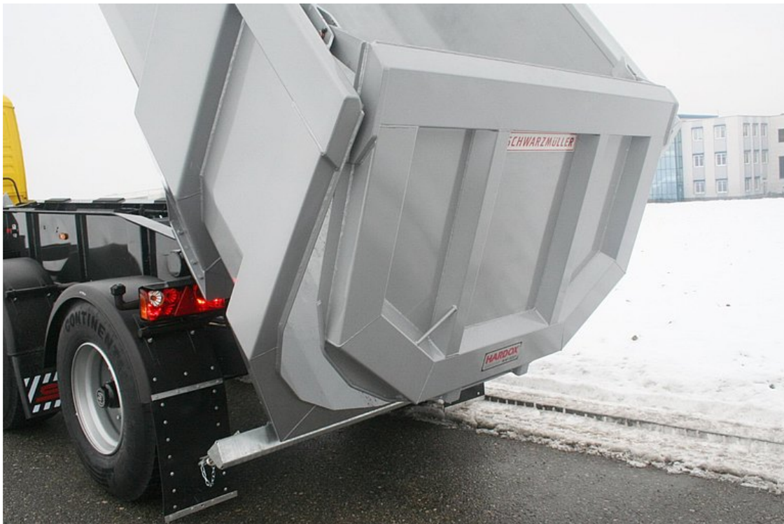
Hátfal = billenő kivitel, süllyesztett csapágazással és auto-mechanikus dupla zárral
