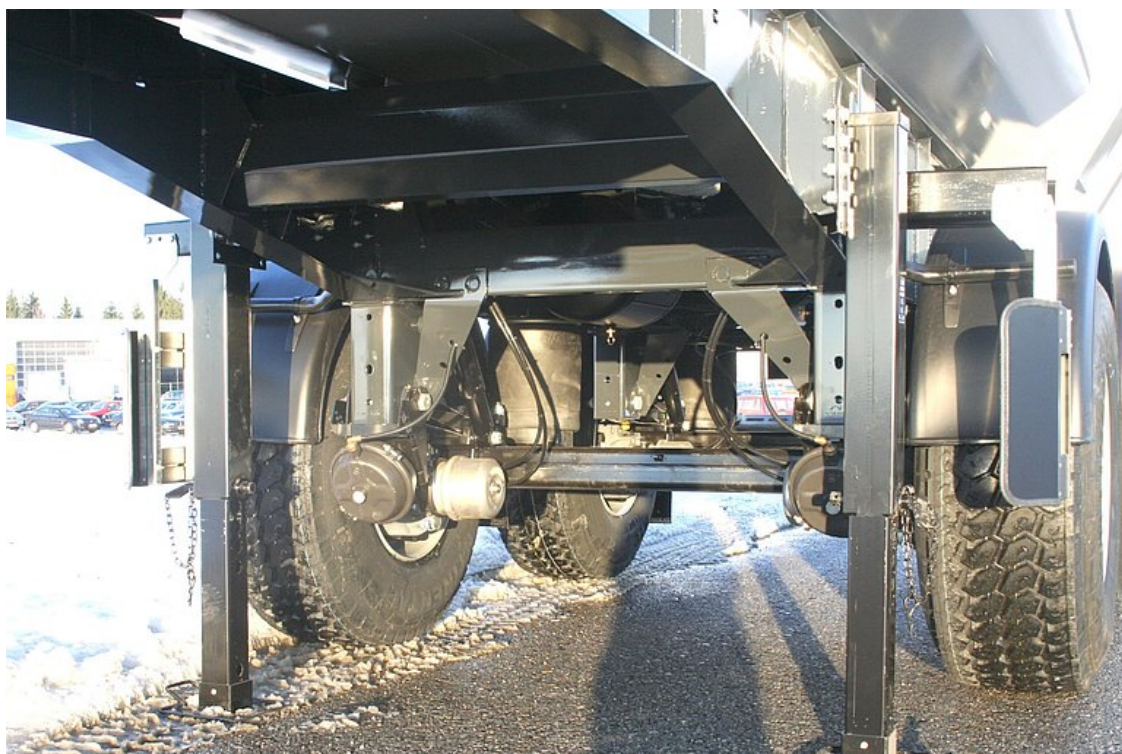
Stabil és csavarodásálló alvázkonstrukció, torzióscsövekkel kiegészítve
