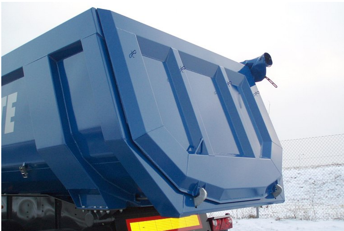
OPCIONÁLIS: kívülre záródó hátfal - biztosítva a nagyobb térfogatot
