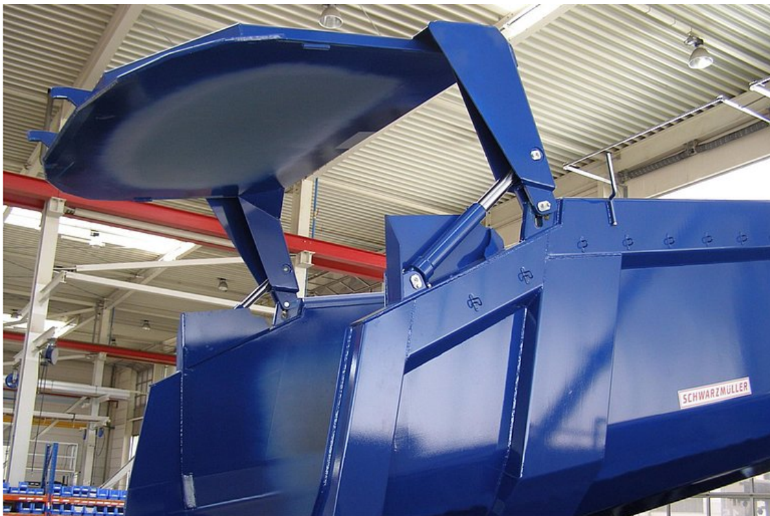
OPCIONÁLIS: különleges kibillenő hátfal a kivételesen magas nyíláshoz, süllyesztett csapágazással és auto-hidraulikus kezeléssel
