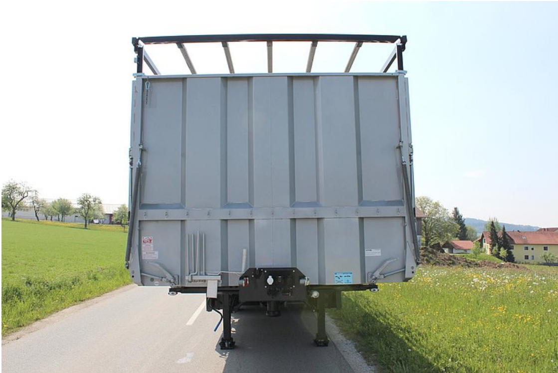
Rögzített acéllemez mellfal, 3 mm vastag
