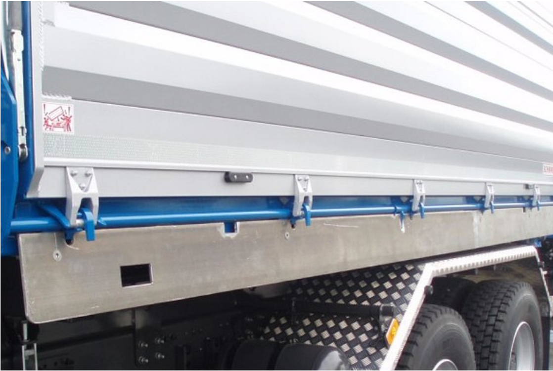
OPCIONÁLIS: alumínium fedél az oldalsó központi reteszelő tengelyén
