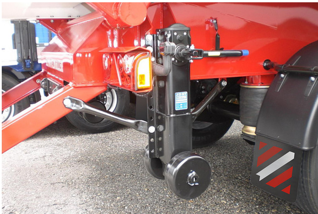
OPCIONÁLIS: 2 az alváz végében elhelyezett acél kitámasztóláb görgőkkel
