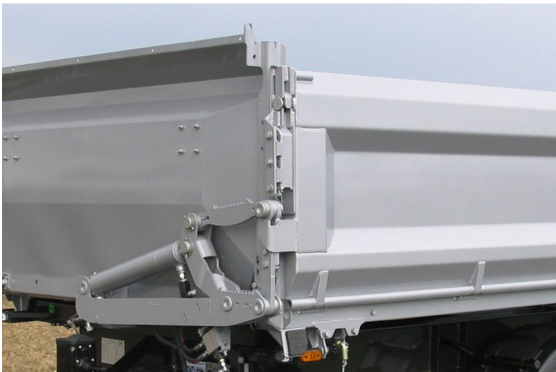
OPCIONÁLIS: bal oldali Bordmatic = hidraulikusan kinyíló oldalfalak
