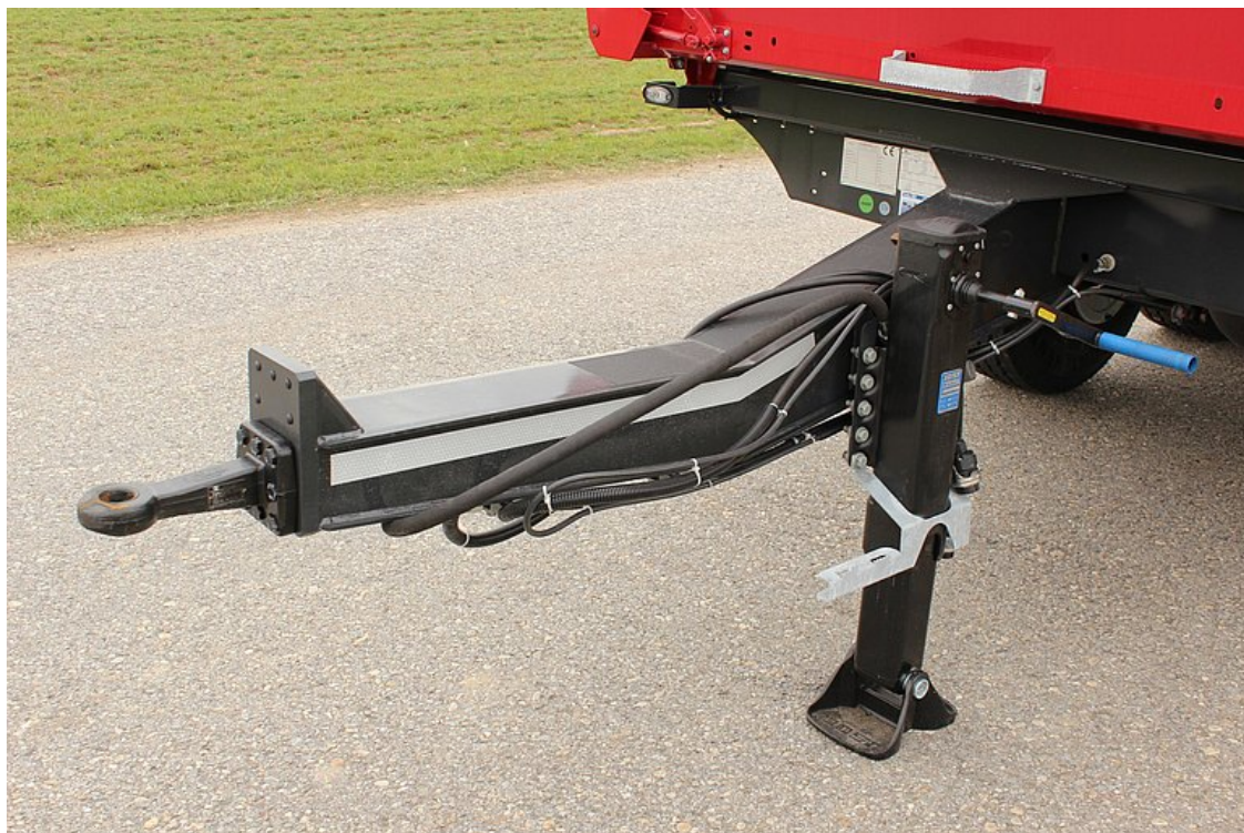
Hajlított vonórúd, állítható magasságú vonószemmel és 1 fellépővel a menetirány szerinti bal oldalon
