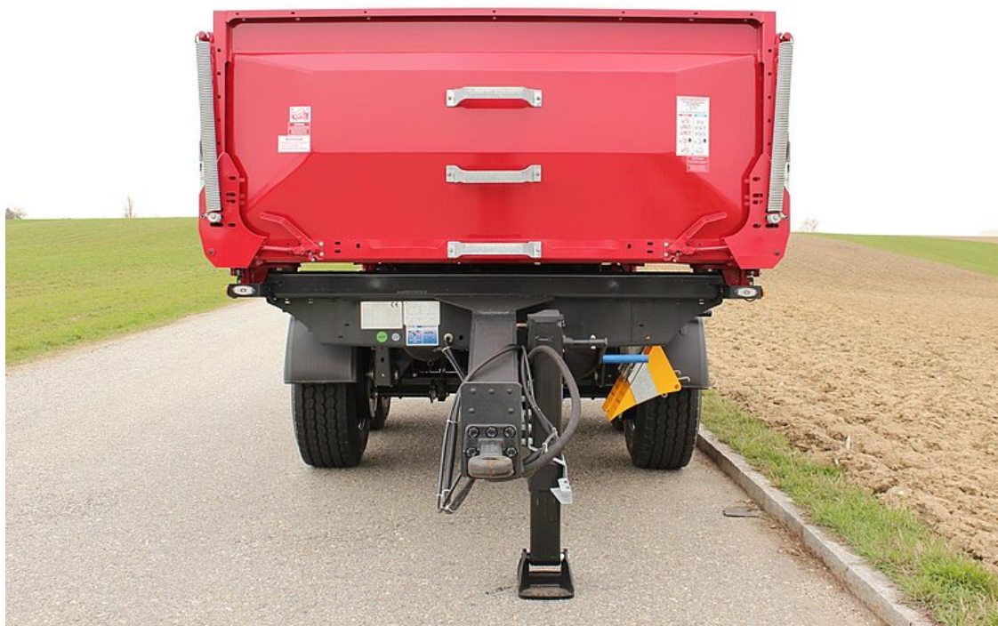
Acéllemez mellfal, kívül-belül fellépővel
