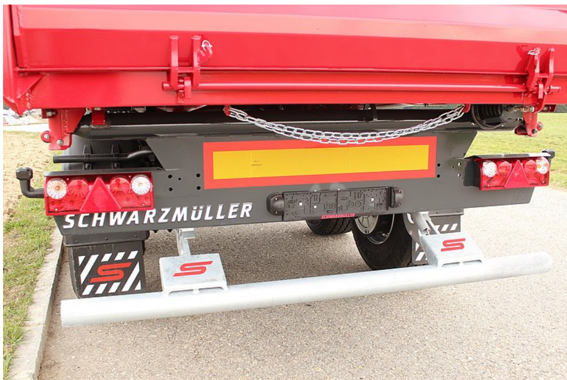
Felhajtható acélcső hátsó aláfutásgátló, ütközővel, Finisher használathoz
