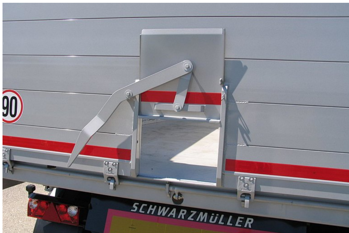
OPCIONÁLIS: hátfalban 400/400 mm gabonaablak, adagolókarral és vízzáró lemezzel
