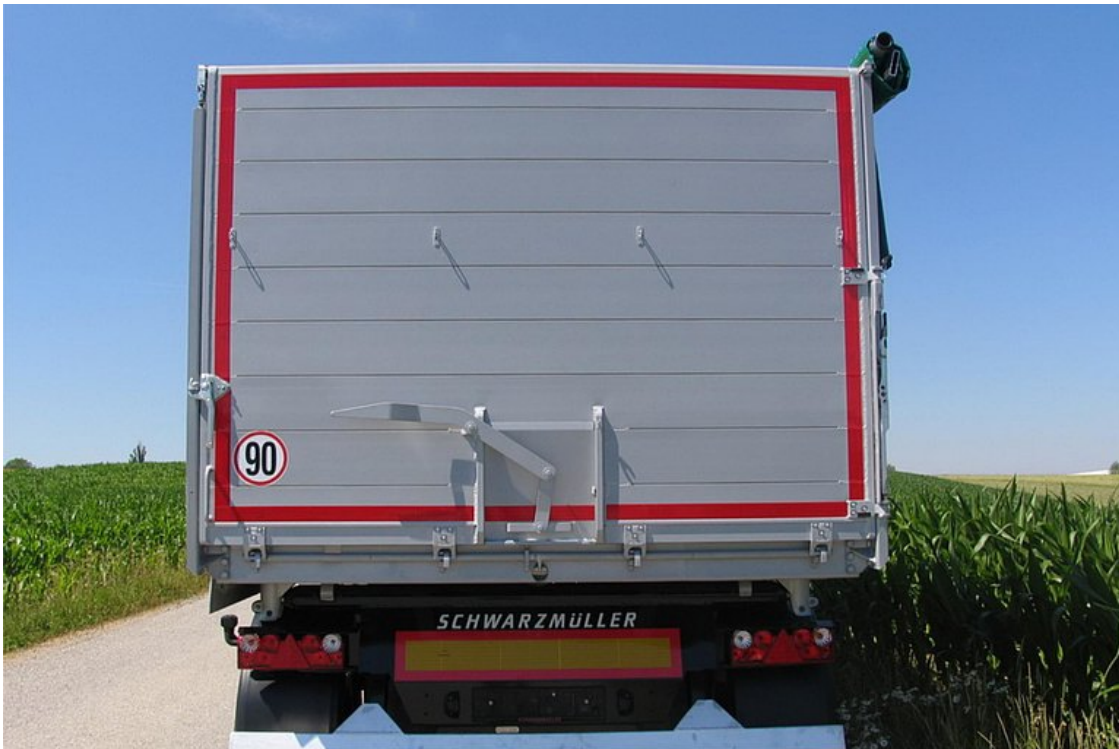
Lehajtható és a központi reteszelés oldásával kibillenthető, üreges alumínium profil hátfal, opcionálisan ajtószárnyként nyitható
